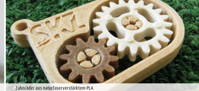
Zahnräder aus naturfaserverstärktem PLA
