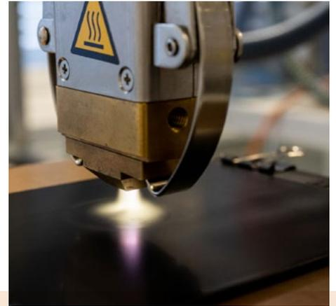
Oberflächenaktivierung mit statischem Atmosphärendruckplasma (Foto: SKZ)
