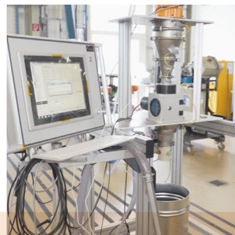
Das entwickelte Farbmesssystem für Schüttgüter (Foto: SKZ)
