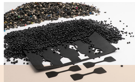
Mahlgut, Rezyklatcompound, Folie und Probekörper für den Strain Hardening Test. (Foto: Luca Hoffmannbeck, SKZ)
