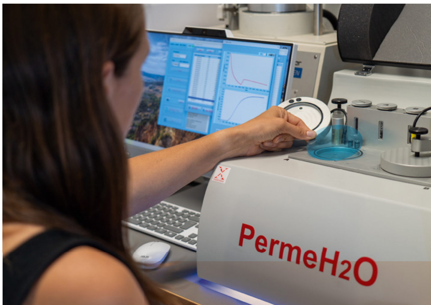
PermeH 2 O – Messgerät zur Wasserdampfdurchlässigkeit (Foto: Luca Hoffmannbeck, SKZ)
