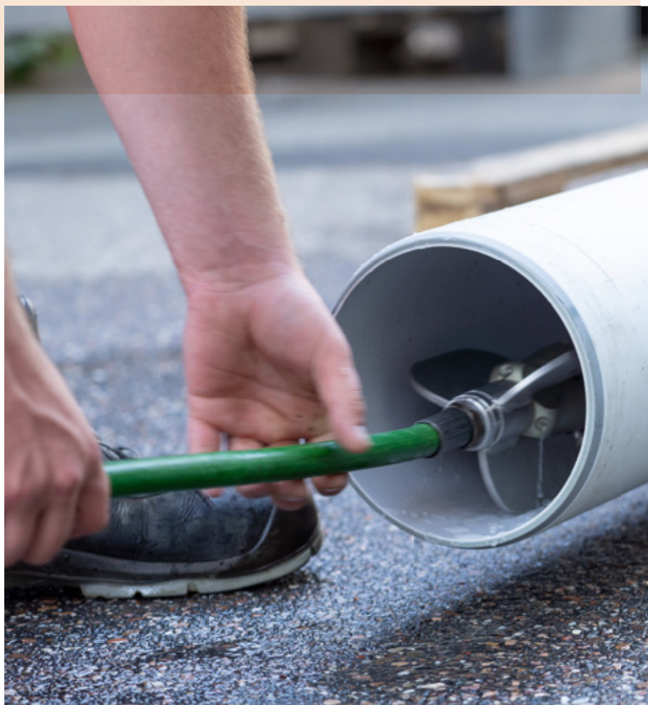
Praxischeck zur Reinigungsbelastung von Kunststoffrohren (Foto: Luca Hoffmannbeck, SKZ)
