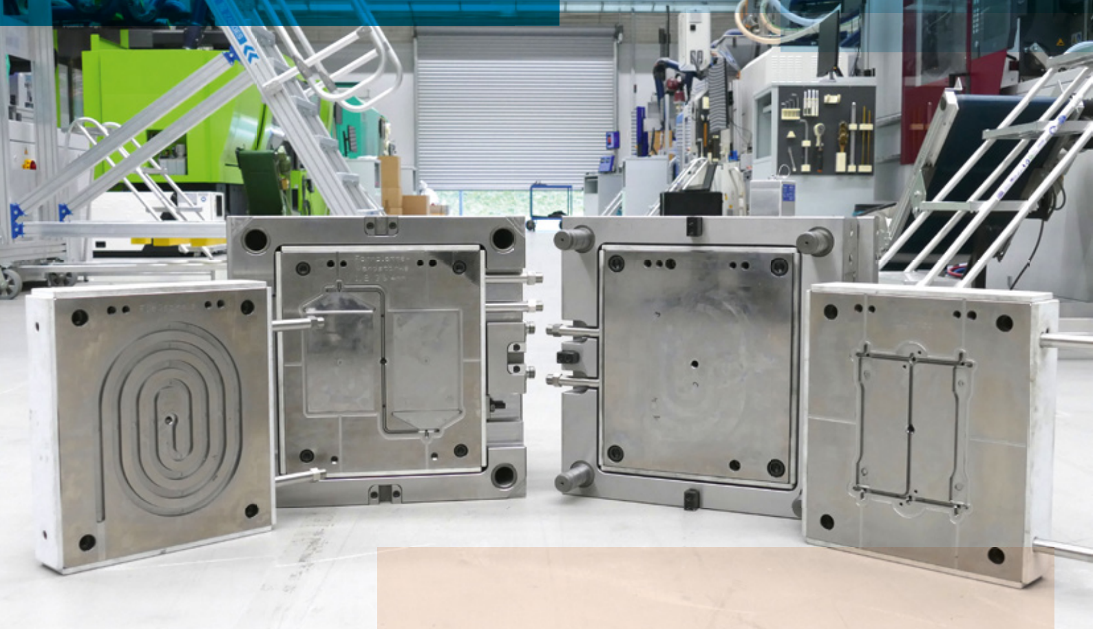
Neues Spritzgießwerkzeug für Duroplaste und Thermoplaste (Foto: Christian Deubel, SKZ)
