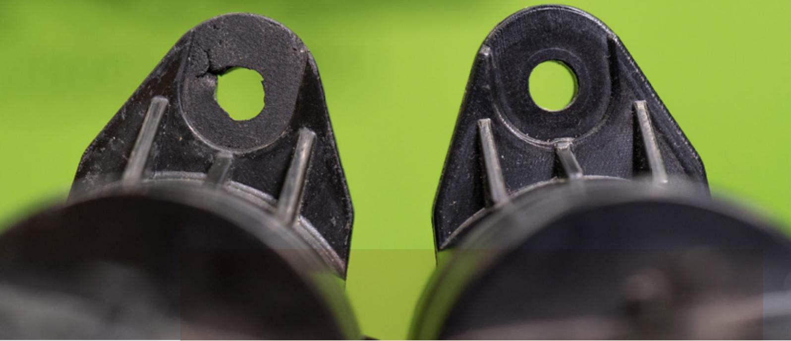
Formteildefekt am linken Bauteil: Unzureichende Nachdruckübertragung im Bereich der Montagehalterung hervorgerufen durch unregelmäßig variierende unverdichtete Fließfrontbereiche, die zu Füllverlaufsunterschieden führen. (Foto: Luca Hoffmannbeck, SKZ)
