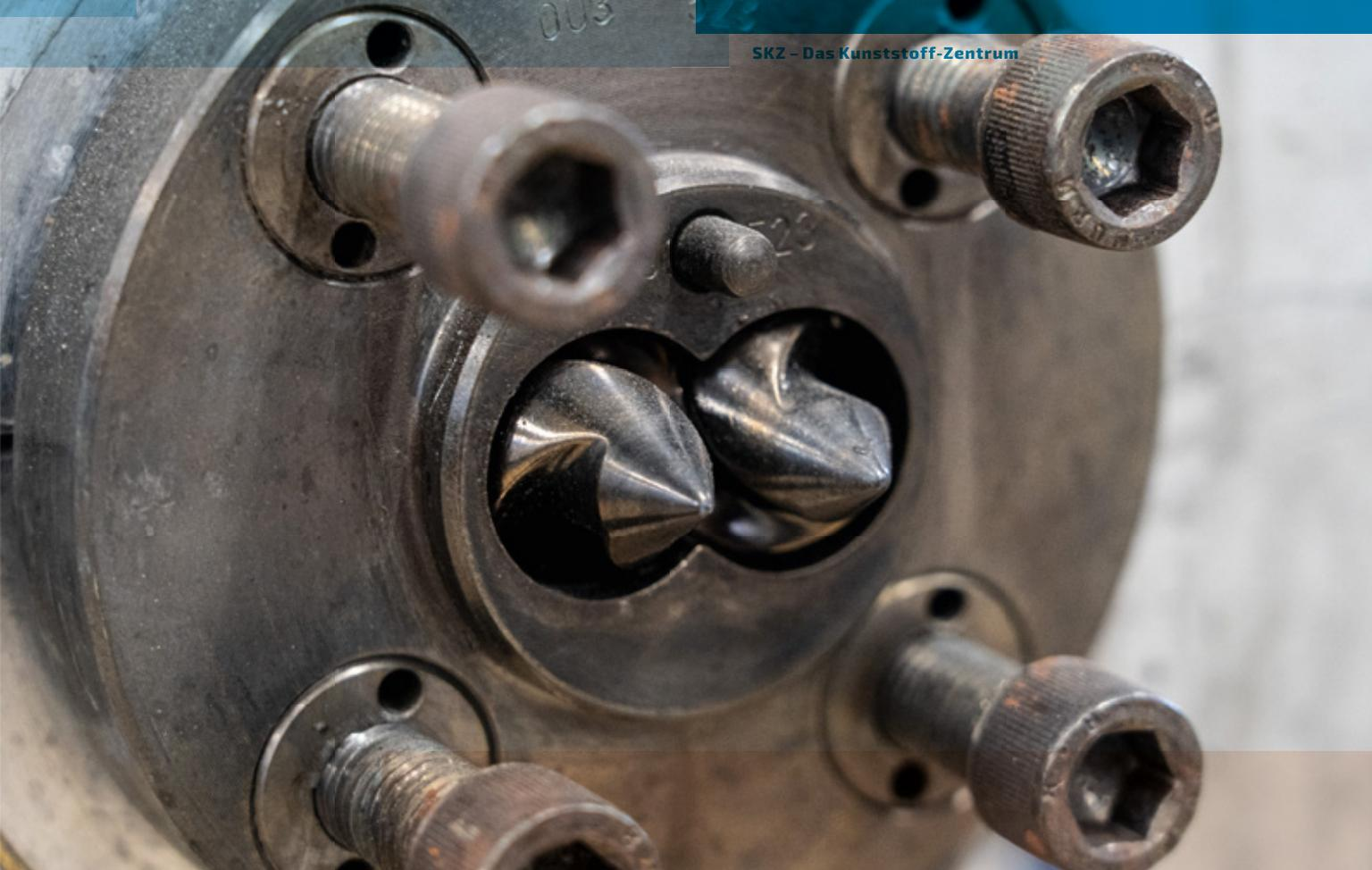
Der Doppelschneckenextruder ist ein weit verbreiteter Extrudertyp in der Kunststoffverarbeitung. Die Simulation des Aufschmelzverhaltens ist jedoch aktuell noch nicht präzise möglich. (Foto: Luca Hoffmannbeck, SKZ)
