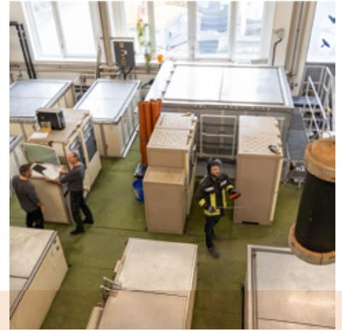
Prüfbereich für die Rohr-Innendruckprüfung (Zeitstand-Prüfung) mit unterschiedlich temperierten Wasserbecken. (Foto: Luca Hoffmannbeck, SKZ)
