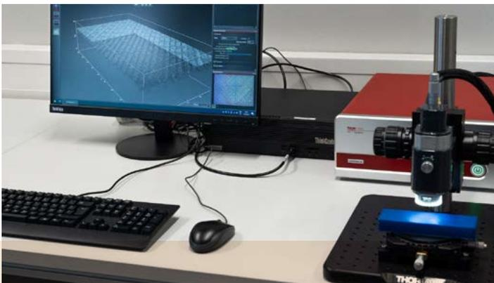
OCT-System beim Scannen einer 3D-gedruckten Kunststoffoberfläche zur Detektion innenliegender Fehlstellen und zur Schichtdickenmessung. (Foto: SKZ)
