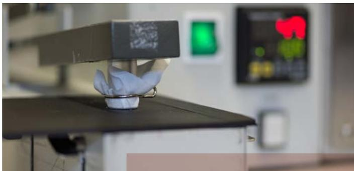
Abriebprüfung Crockmeter-Test (Bild: SKZ)
