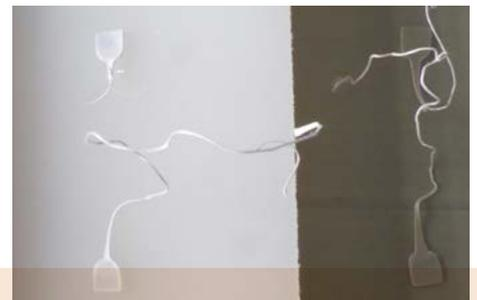
Probekörper nach einem erfolgten Strain Hardening Test. (Foto: SKZ)
