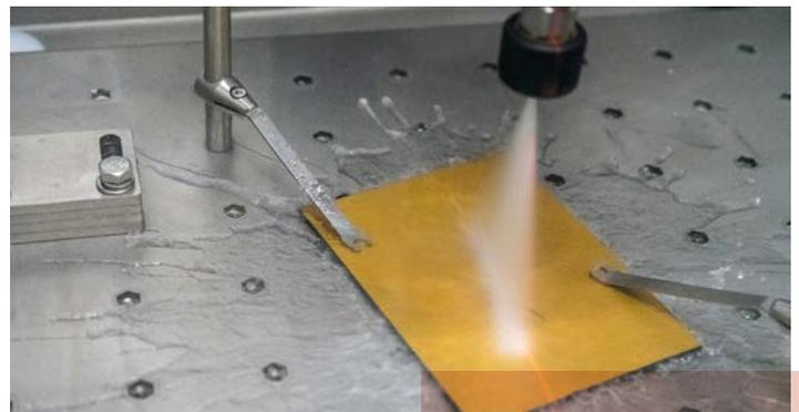
Dampfstrahlprüfung (Bild: SKZ)
