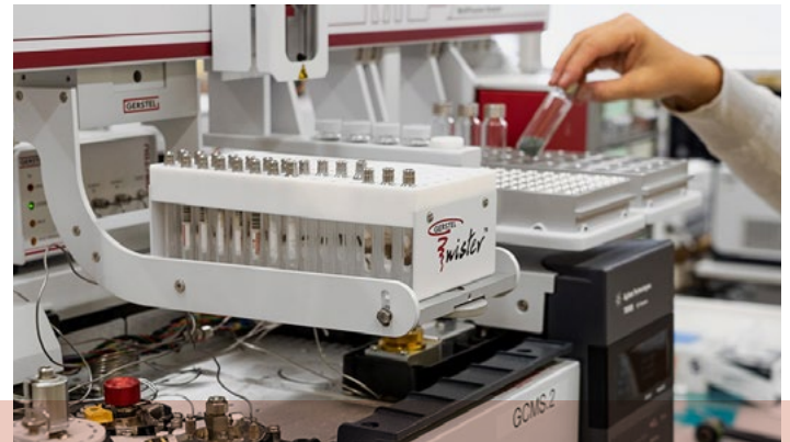
Das Prüflabor der ASO untersucht das Emissionsverhalten von Bauteilen, die direkt oder indirekt mit der Fahrzeuginnenraumluft in Kontakt stehen. (Foto: SKZ)
