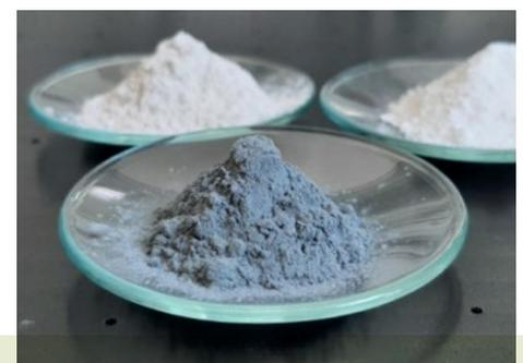
Untersuchte keramische Pulver im Rahmen der Ringversuche (Foto: SKZ)
