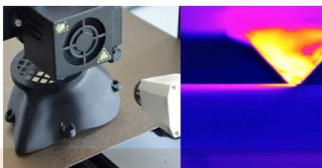
Durch Einsatz der Thermografie lassen sich bereits frühzeitig Fehlermerkmale bei additiv gefertigten Bauteilen erkennen. (Foto: SKZ)
