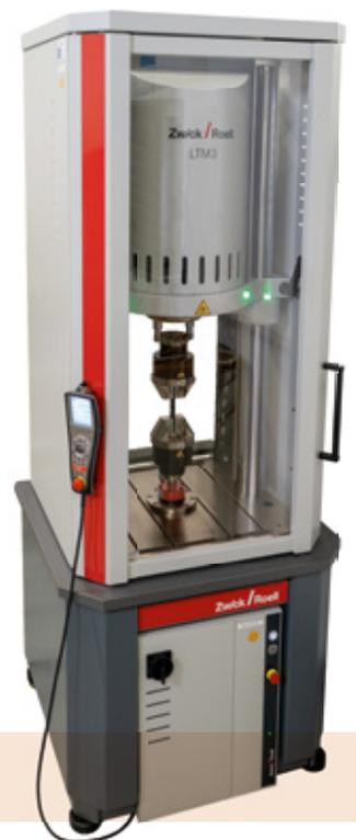
Cracked Round Bar (CRB) Test nach ISO 18489 (Foto: SKZ)
