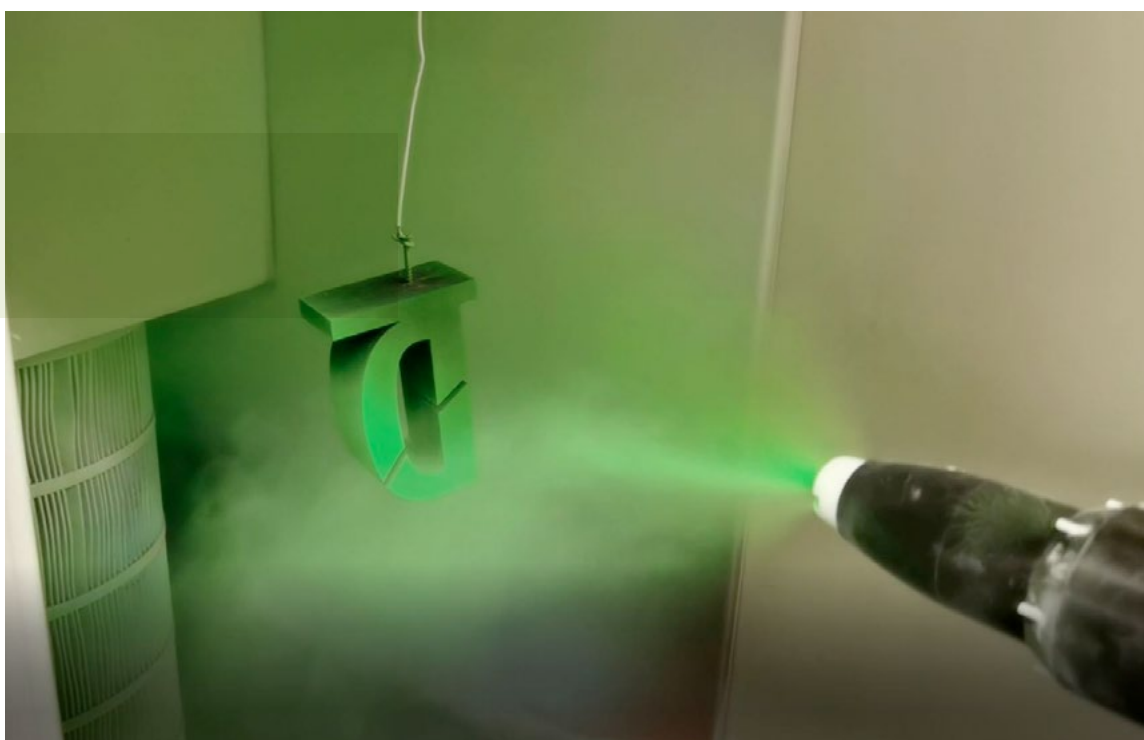
Sprühversuch mit einer Pulversprühpistole mit Corona-Aufladung. (Foto: EZD)
