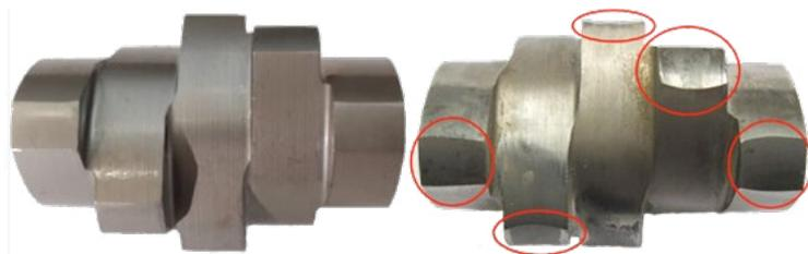
Ein neuwertiges Schneckenerelement (links) und ein verschlissenes Schneckenerelement (rechts). (Foto: SKZ)
