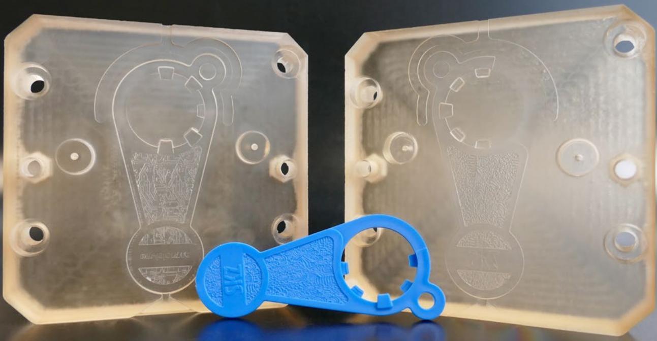
In Form gebracht: Gedruckte Werkzeugeinsätze können dem Thermoplast-Schaumspritzgießen die entscheidende Wende bringen. (Foto: SKZ)
