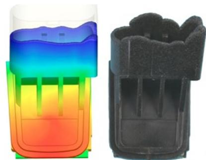
Simulierte und reale Füllstudie eines Steckermoduls aus Epoxidharz (Bild: SKZ)
