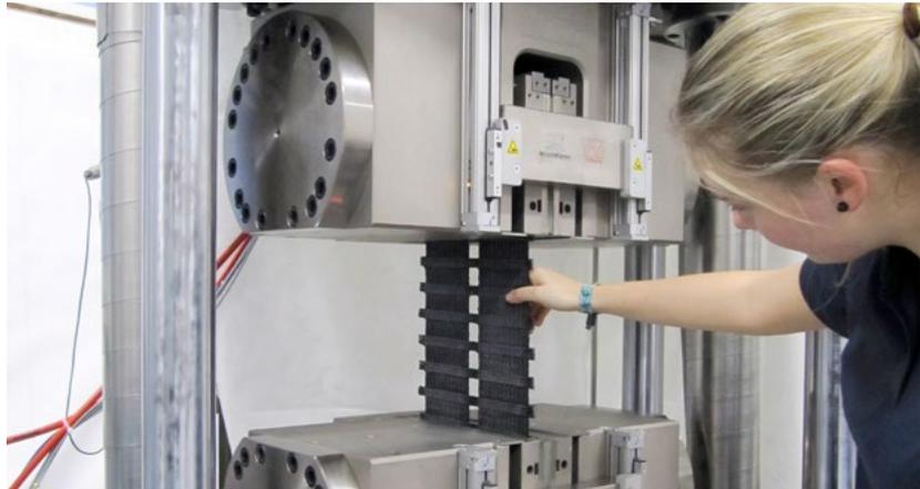
SKZ-Mitarbeiterin an der Geogitter-Zugmaschine für Festigkeiten von bis zu 300 kN.
