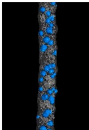
Abb. 2: Strang mit farblich markierten Poren (Bild: SKZ)
