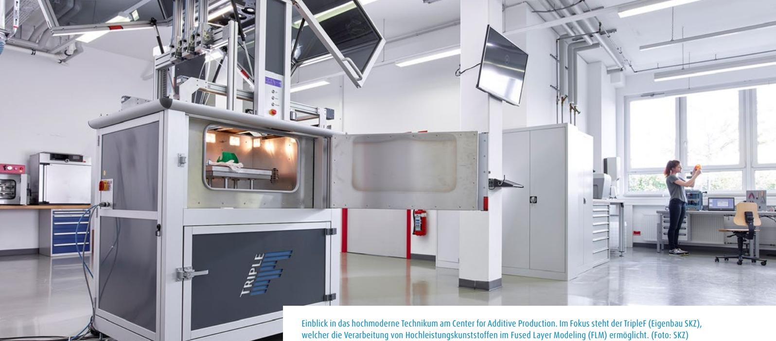
Einblick in das hochmoderne Technikum am Center for Additive Production. Im Fokus steht der TripleF (Eigenbau SKZ), welcher die Verarbeitung von Hochleistungskunststoffen im Fused Layer Modeling (FLM) ermöglicht. (Foto: SKZ)
