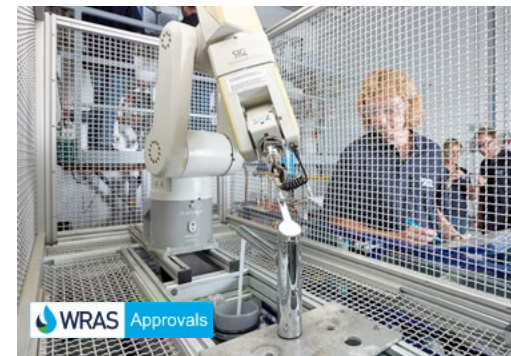
Eine Mitarbeiterin des SKZ bei der Armaturenprüfung (Bild: SKZ)
