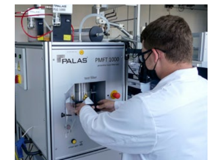
Florian Leikam, Mitglied des SKZ-Projektteams Atemschutz, testet Atemschutzmasken am neuen Prüfgerät „Palas“. (Bild: SKZ)
