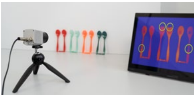
Das SKZ bietet ein speziell für den Spritzguss konzipiertes Inline-Messsystem zur Detektion typischer Fehlstellen an. Dabei können sowohl oberflächliche als auch innenliegende Fehlstellen, die mit bloßem Auge nicht sichtbar sind, zuverlässig erfasst werden. (Bild: SKZ)
