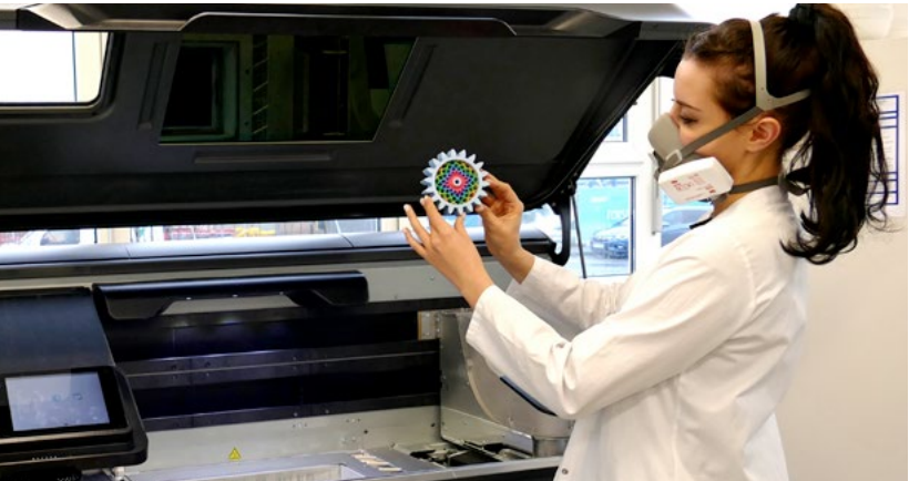
Der Jet Fusion 580 im Technologie-Zentrum des SKZ mit der wissenschaftlichen Mitarbeiterin Anne Gruska beim Entpacken eines Baujobs. (Bild: SKZ)
