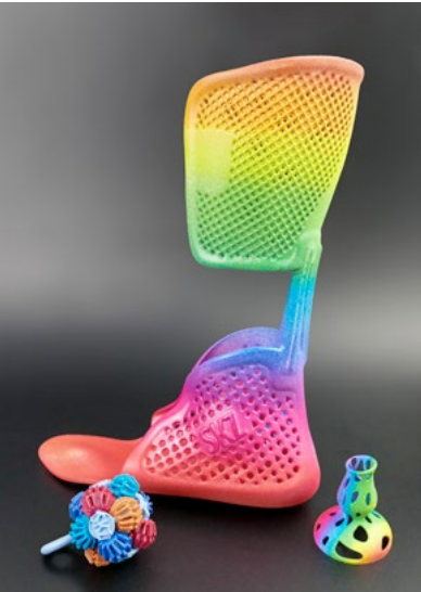
Bauteile wie die Fußorthese (Mitte) werden am SKZ mittels MJF-Verfahren gefertigt und bereits während des Druckprozesses eingefärbt. (Bild: SKZ)
