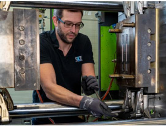
Die Spannbacken der Firma Lenzkes beim Einsatz an einer Spritzgießmaschine am SKZ. (Bild: SKZ)
