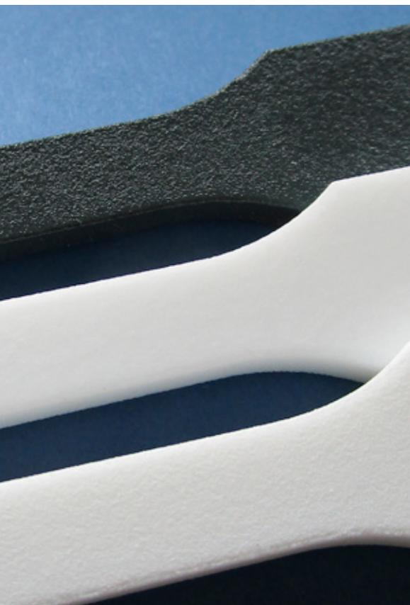
Lasergesinterte Zugstäbe aus Polyamid: unbehandelt (unten), geglättet (mittig) und lackiert (oben). (Bild: SKZ)
