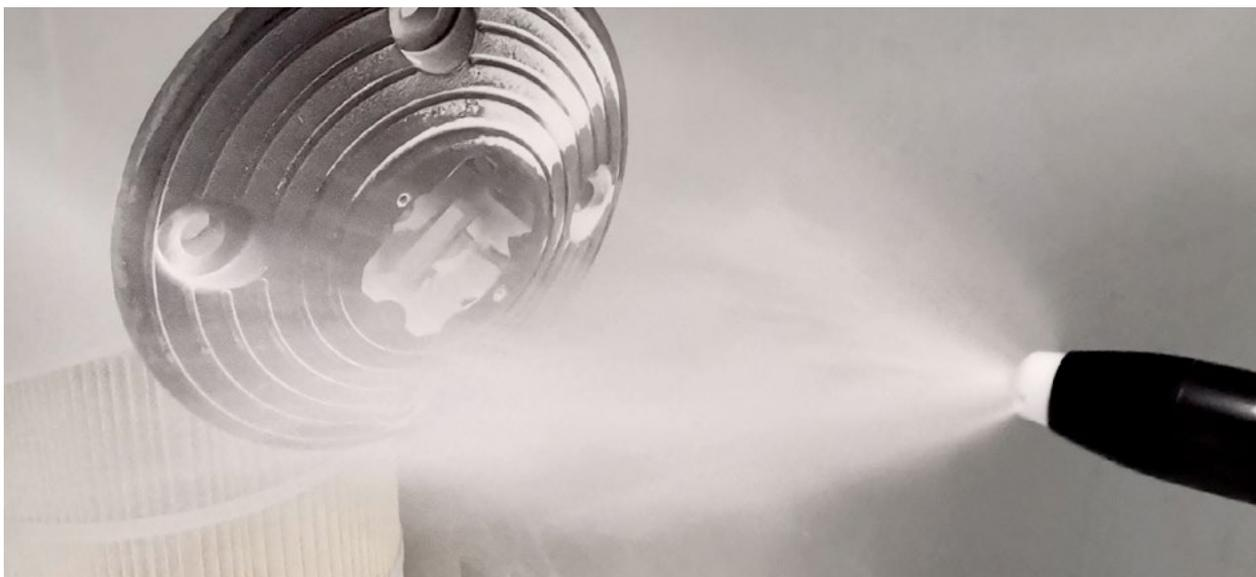
Pulverbeschichtung eines 3D Kunststoffbauteiles
