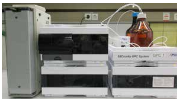
Abb. 3: GPC-System; links: Ofen, der die Trennsäule(n) beinhaltet; mittig: Autosampler und Detektor; rechts: Pumpe und Lösungsmittelvorrat mit Entgasungseinheit.
