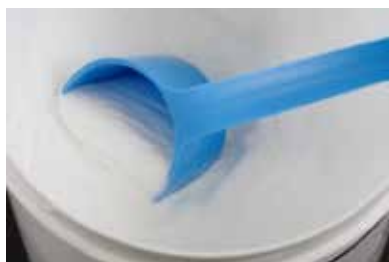
Abb. 1: Acrylat-Komponente eines Einbettmittels. U.a. wird die Endhärte durch die mittlere Molmasse des Polymers beeinflusst.
