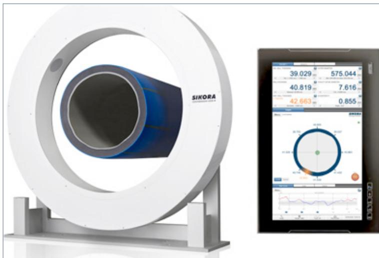
ankopplung benötigt wird. Der apparative Aufwand ist damit signifikant geringer, was erfahrungsgemäß mit einer hohen industriellen Akzeptanz einhergeht. Weiterhin ist diese Messmethode temperaturunabhängig, sodass die Wanddicke erstmals unabhängig von extrusionsbedingten Temperaturänderungen zuverlässig und reproduzierbar ermittelt werden kann.
