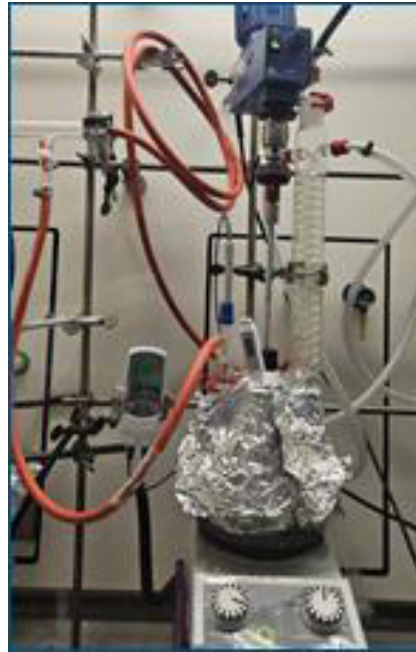
Abbildung 3: Aufbau der Apparatur für die Glykolyse im Labormaßstab.
