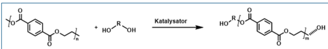
Abbildung 1: Komponenten der Reaktion für die Glykolyse von PET (links: rezykliertes PET und Glykol), Katalysator und erwartetes Produkt (Oligomer).
