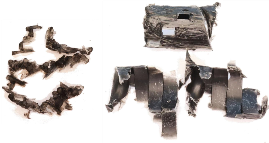
Abbildung 51: Beispielhafte Darstellung von einer unvollständig aufgeschmolzenen Probe (links) und einer aufgeschmolzenen Probe (rechts) nach der Entnahme am Doppelschneckenextruder
