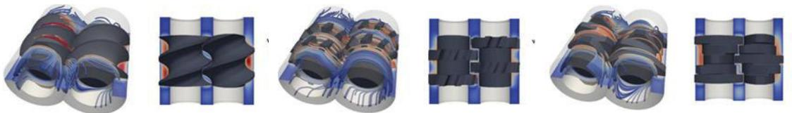
Abbildung 2-7: Geschwindigkeitsprofil des Förderelements (links), eines Mischelements (mittig) und eines Knetelements (rechts) nach einer kompletten Umdrehung (Zeit = 0,5 s).
