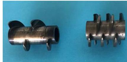
Abbildung 2-1: Ko-Kneter Gesamtaufbau (links, [18]) und Aufnahme eines Fördererelements Typ C1 und eines Mischelements (Typ KN) eines MX30 BUSS Ko-Kneters (rechts).
