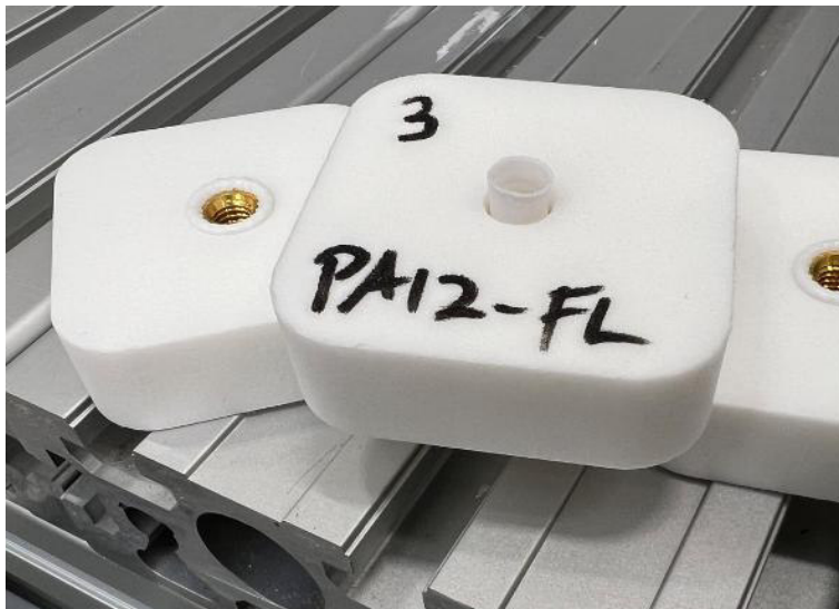
Abbildung 44: Darstellung des Fehlerbildes eines ausgeworfenen Materialzylinders nach der Ultraschalleinbettung an SLS-Probekörpern aus PA12
