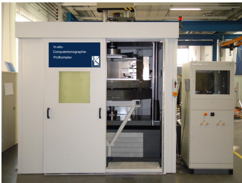
Abbildung 46: In-situ CT-Prüfkomplex FCTS 160-IS mit einer maximalen Auflösung von 10\ \mu\text{m}
