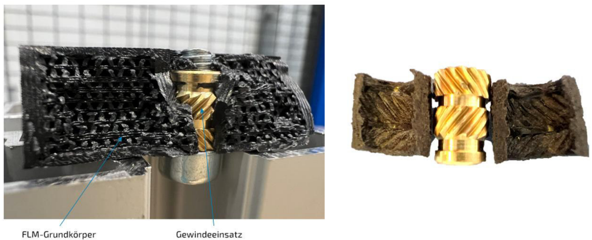
Abbildung 38: Darstellung der exemplarischen Versagensarten für Probekörper aller untersuchten Materialsysteme nach der Torsionsprüfung (links) und freigelegte Fügezone mit erkennbaren „überdrehten“ Hinterschnittbereichen (rechts)
