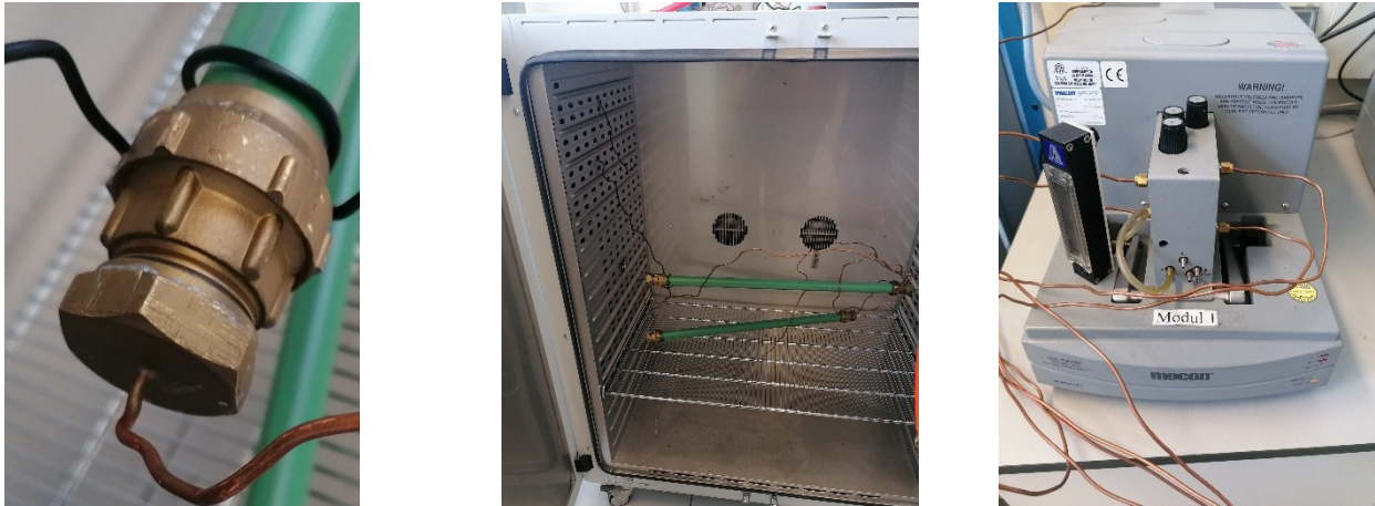
Abbildung 3: Abdichtung des Rohres für die Permeationsmessungen (links) sowie Rohre in der Temperierkammer (mitte) und der Anschluss an das Messgerät (rechts).
