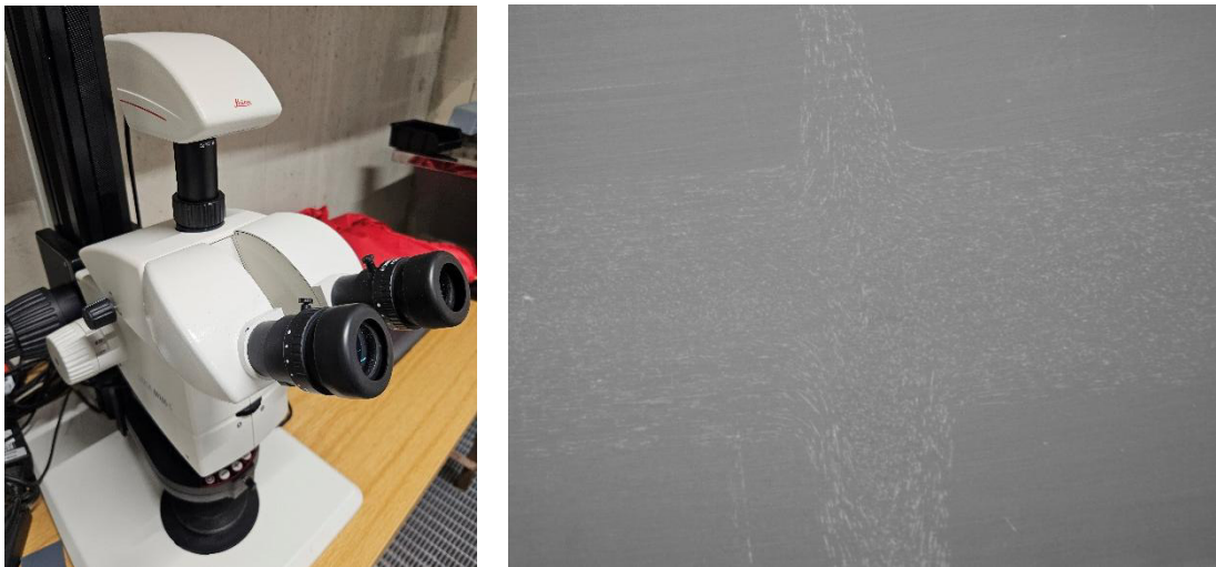
Abbildung 13: Mikroskop Leica M165 C (links) und Beispiel einer Mikroskopieaufnahme einer Fügeebene von geschweißten GF-Rohren (rechts).
