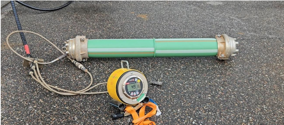
Abbildung 17: Versuchsaufbau der Berstdruckprüfung.
