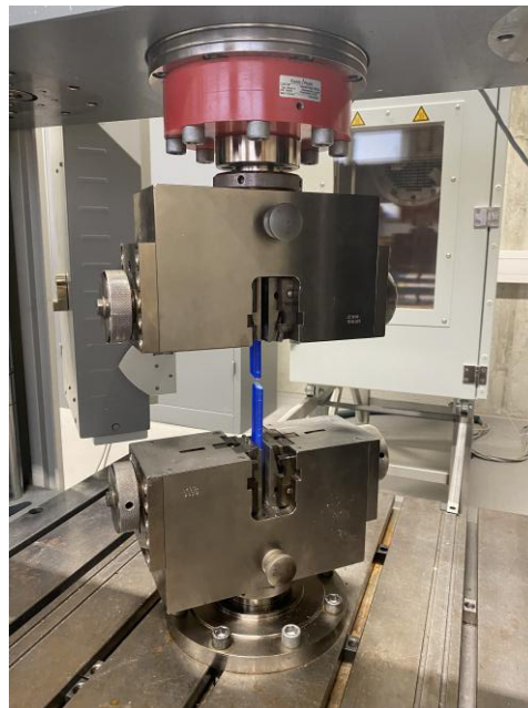
Abbildung 15: Zugprüfung an der Z250.
