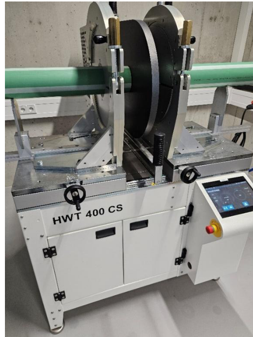
Abbildung 12: Werkstattmaschine HÜRNER HWT 400 CS.
