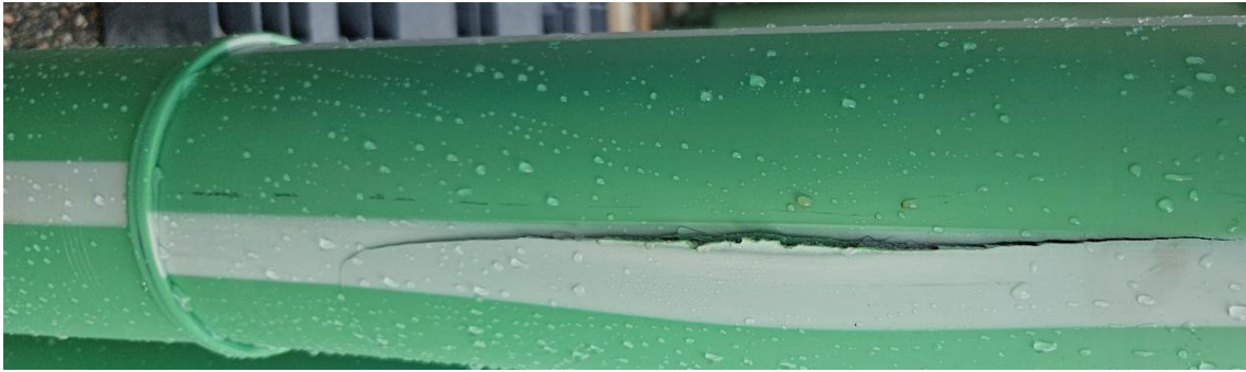
Abbildung 28: Versagen im Grundmaterial bei der Berstdruckprüfung des geschweißten Rohrs.
