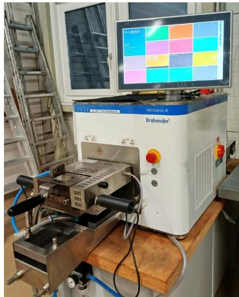
Abbildung 4-3: Metastation 4E mit Messkneter 50 EHT, Firma Anton Paar Germany GmbH
