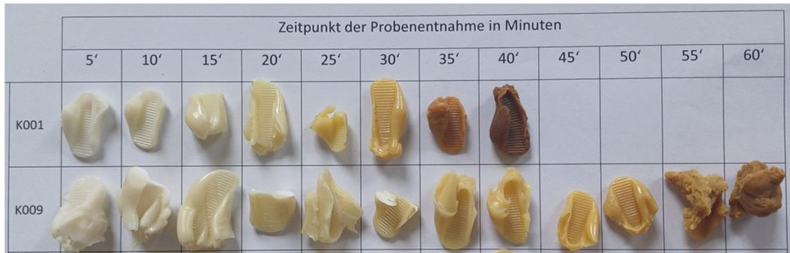
Abbildung 5-2: Farbliche Änderung der PVC-Proben mit unterschiedlichen Stabilisatorkonzentrationen
