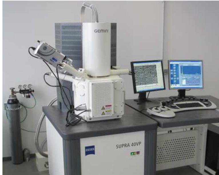
Abbildung 4-11: Feldemissions-Rasterelektronenmikroskop Supra 40VP
