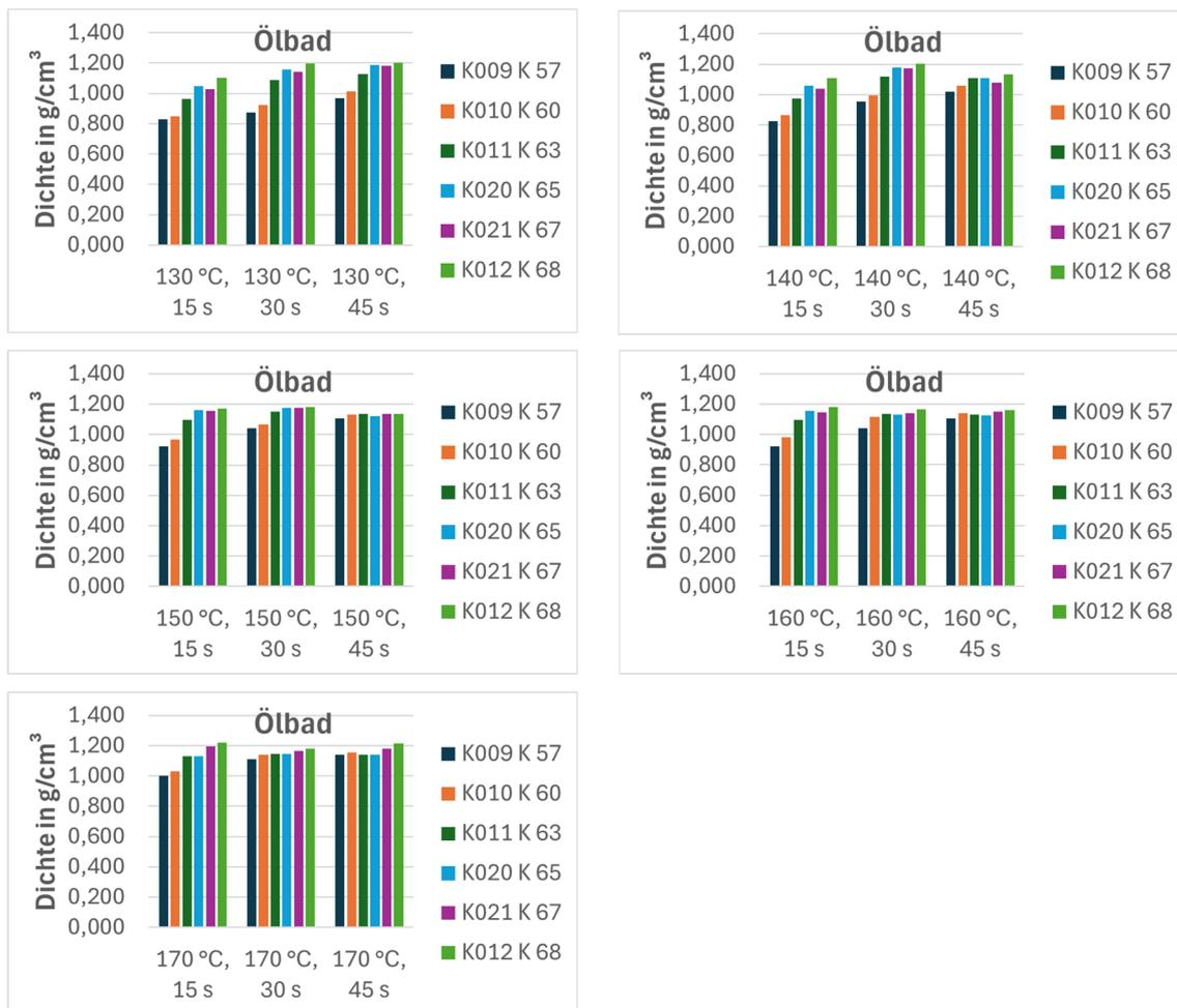
Abbildung 5-13: Ergebnisse des Aufschäumens im Ölbad bei verschiedenen Temperaturen und unterschiedlichen Zeiten
