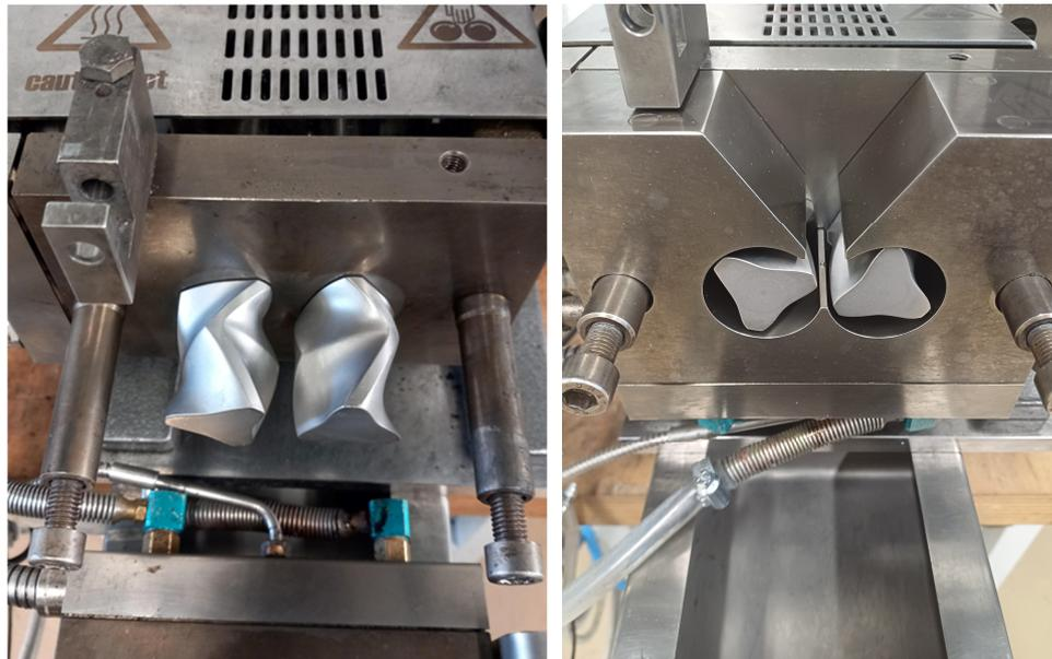
Abbildung 4-4: Schaufeln des Messkneteters, links: frei liegend, rechts: in der Kneterkammer eingebaut
