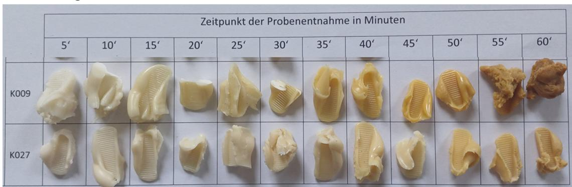
Abbildung 5-5: Farbliche Änderung der PVC-Proben mit und ohne Zugabe von Kreide
