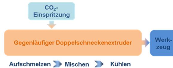
Abbildung 4-12: Schematischer Verfahrensaufbau der Extrusionsanlage
