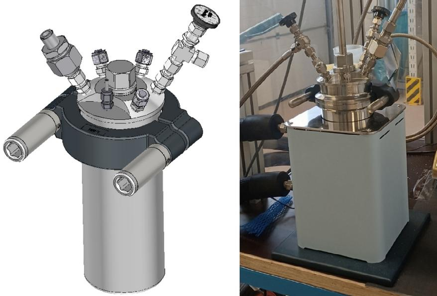
Abbildung 4-7: links: Hochdruck-Laborreaktor BR-500, rechts: Autoklav mit Thermostatisiermantel BTM-500, beides Firma Berghof Products + Instruments GmbH
