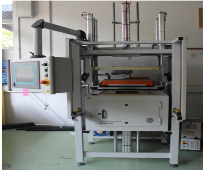
Abbildung 4-10: Vakuumentziehmaschine Berg M5 der Firma Berg Engineering GmbH
