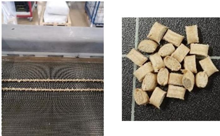
Abbildung 20: Foto der extrudierten WPC-Stränge und des erhaltenen Granulats nach Kaltabschlag
