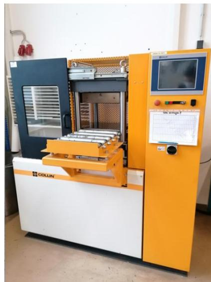
Abbildung 13: Zur Herstellung von WPC-Platten eingesetzte Presse am SKZ
