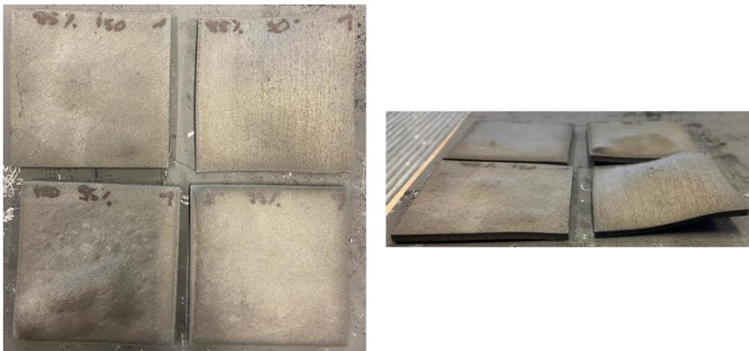
Abbildung 37: Deformierte, pyrolysierte Platten basierend auf Rezeptur 304 (N28/H30/E42)
