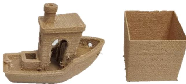
Abbildung 31: Mittels FFF produzierte Demonstratorbauteile
