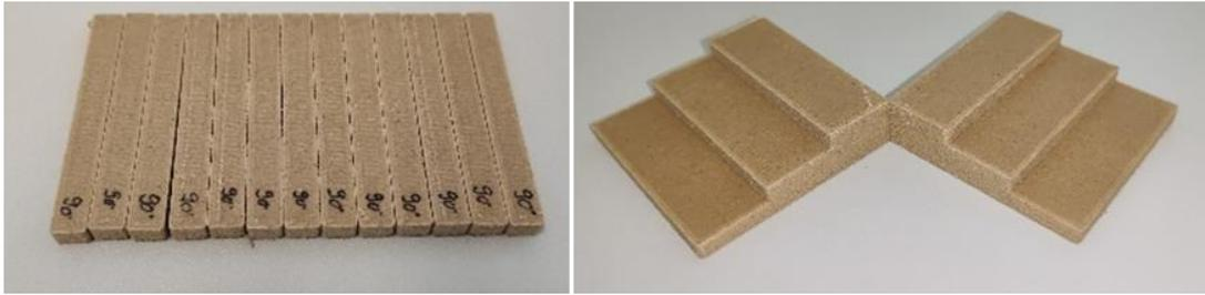
Abbildung 30: Additiv gefertigte (FFF) Probekörper auf Basis von Rezeptur 304: Biegestäbchen (mit Strangablage  $90^\circ$  zur Längsrichtung) (links) und Treppengeometrie (Strangablage  $45^\circ$  alternierend) (rechts)
