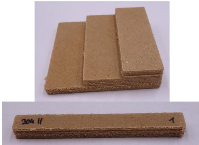
Abbildung 26: Fotos der mittels FGF hergestellten stufenförmigen Probekörper und Biegestäbchen
