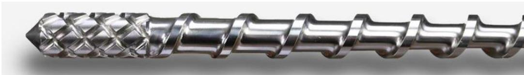
Abbildung 10: Einschnecke mit Mischkopf der Filamentlinie im Labormaßstab
