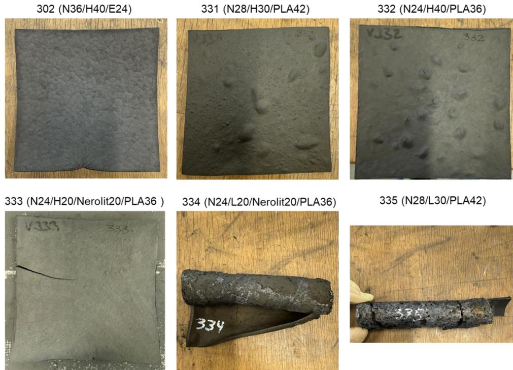
Abbildung 40: Pyrolysierte Platten der Rezeptur 302 und 331 bis 335
