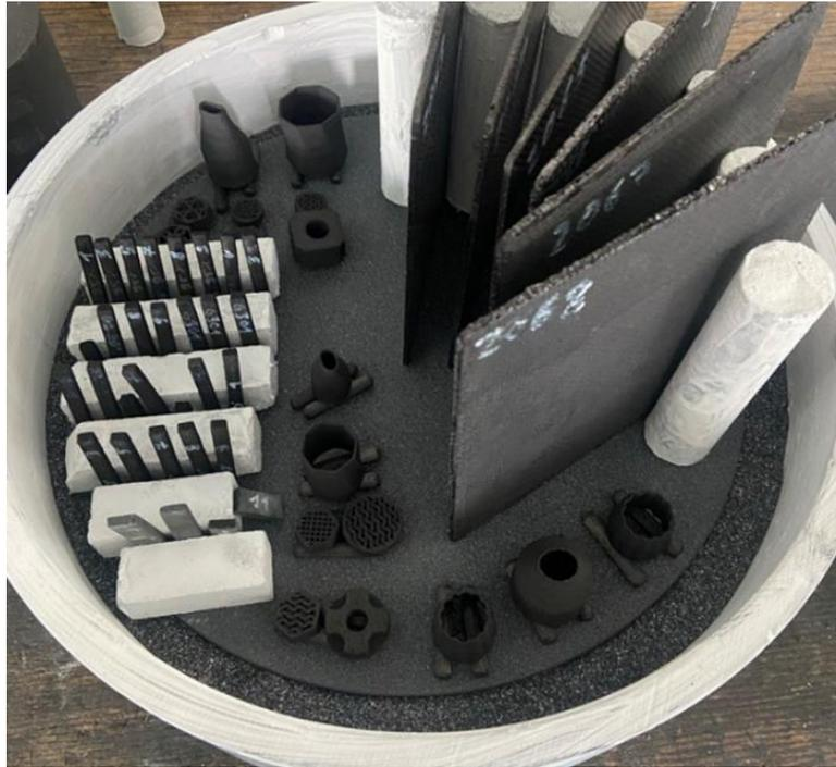
Abbildung 15: Silizieraufbau mit Biegestäbchen und auf Dochten platzierten Demonstrator-Teilen auf einer SiC-Pufferplatte
