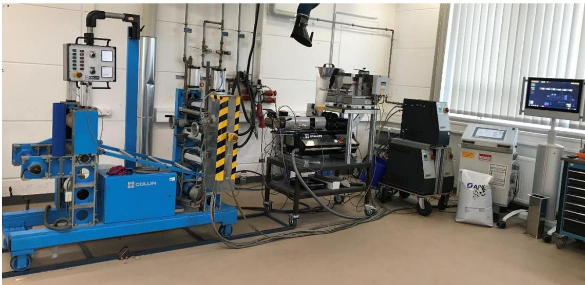
Abbildung 7: Versuchsaufbau zur Folienextrusion.
