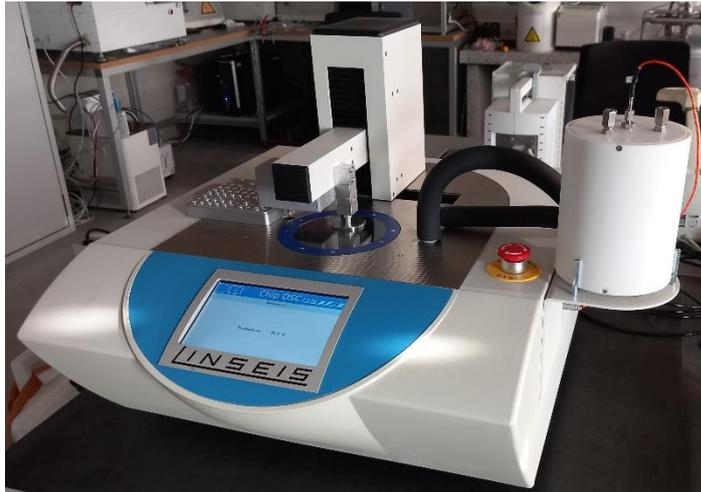
Abbildung 12: DSC zur Bestimmung der thermischen Eigenschaften der extrudierten Folien. Für die Materialien N1 und N2 sowie R1 bis R4 wurde jeweils eine Probenmenge von ca. 10 mg aus den Folien entnommen, in einen Aluminiumtiegel mit gelochtem Deckel überführt und mit einer Presse verkapselt. Die Messungen erfolgten im Temperaturbereich von 35 bis 250 °C mit einer Aufheiz- und Abkühlrate von 20 K/min. Dabei wurden immer zwei Aufheiz- und eine Abkühlkurve gemessen.
