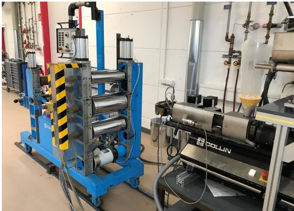
Abbildung 9: 3-Walzlättwerk (links) und Extruder (rechts) für die Folienextrusion.
