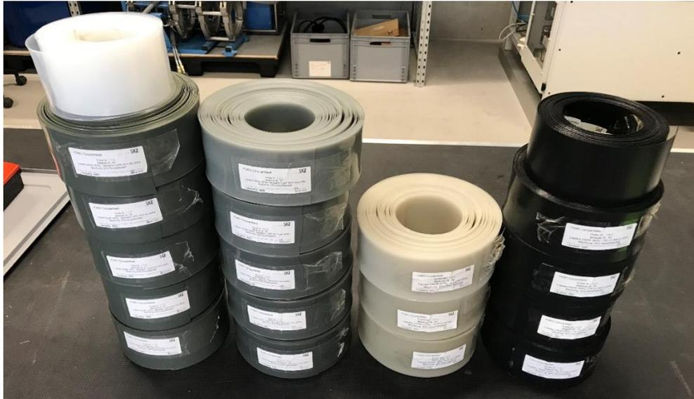
Abbildung 10: Hergestellte Folien mit der Neuware 1 und der jeweiligen Kombination mit den Rezyklaten 1-4, vgl. Tabelle 4. Von links nach rechts: Mischungen mit Rezyklat 1, 2, 3 und 4. Von oben nach unten: Neuware bzw. geringster Rezyklatanteil (20 %) bis höchster Rezyklatanteil (60 bzw. 100 %).
