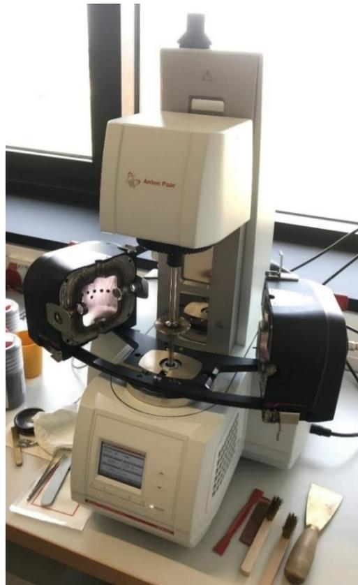
Abbildung 13: Rheometer zur Bestimmung der Fließeigenschaften der verwendeten Materialien.
