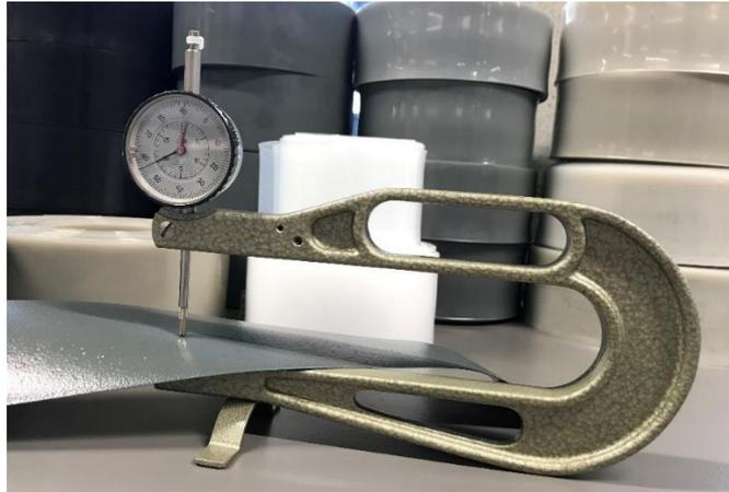
Abbildung 14: Messaufbau zur Dickenmessung der extrudierten Folien.
