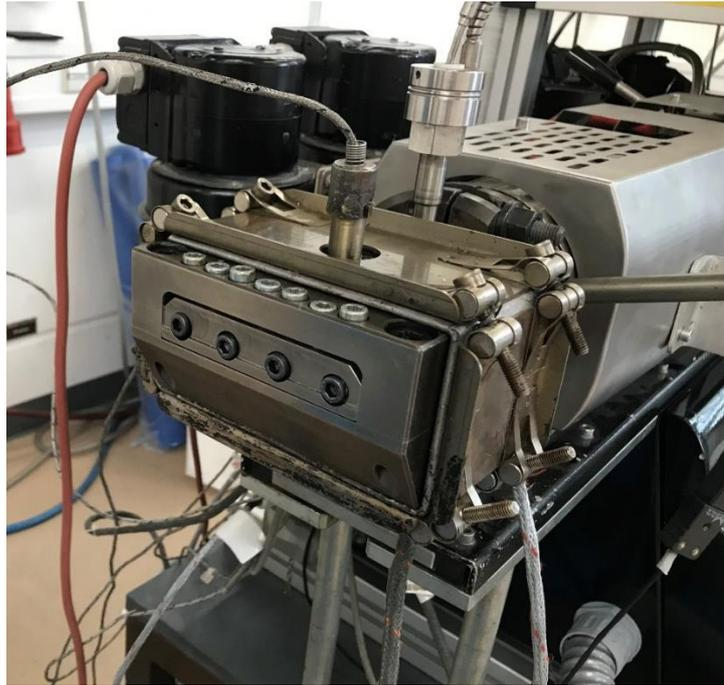
Abbildung 8: Am Extruder angeflanschte Breitschlitzdüse für die Folienextrusion.
