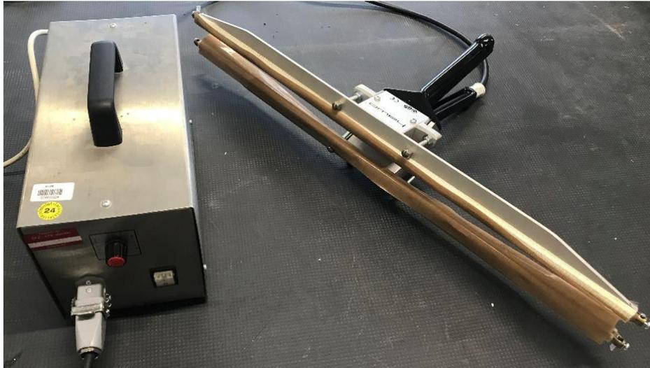
Abbildung 17: Verwendete Schweißzange zum Wärmeimpulsschweißen.
