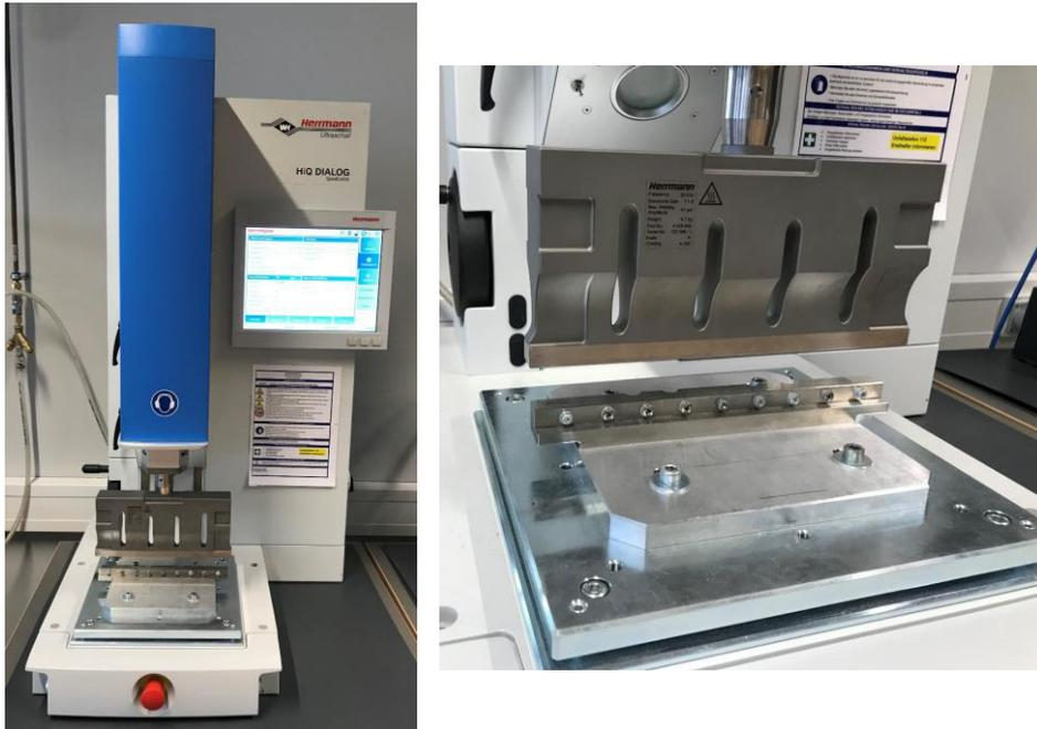
Abbildung 18: Verwendete Anlage zum Ultraschallschweißen (links) und Detaildarstellung von Sonotrode und Amboss (rechts).
