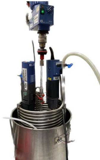
Abbildung 11: Foto von dem Reaktor mit Kühlung für die Herstellung von PA Mikrokapseln. Es sind 2 Rotor-Stator Homogenisatoren, ein Ankermixer und ein Dosierschlauch für die Aminlösung gezeig.
