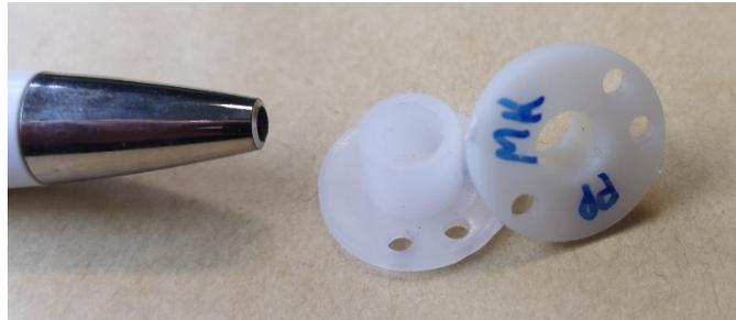
Abbildung 82: Gleitlager aus PP/Schmierstoffmikrokapselcompound hergestellt durch die HESA Kunststofftechnik GmbH & Co. KG.
