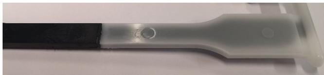
Abbildung 36: POM 2K Bauteil Einspritzen des schwarzen POM (Ultraform N2320 003) in das naturfarbene POM (Kepital F30-03).
