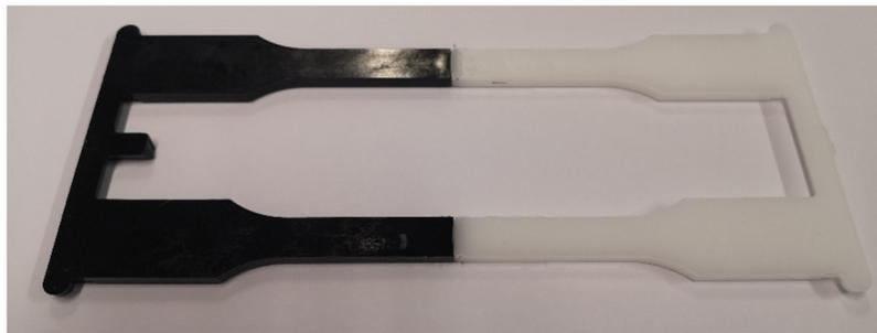
Abbildung 34: 2K-Zugstab zur Untersuchung der Verbundhaftung zweier Kunststoffe.
