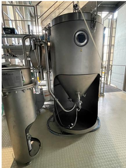
Abbildung 13: Foto des Sprühtrockners (Technikum), der für die Trocknung von größeren Mengen von Mikro kapseln benutzt wurde.
