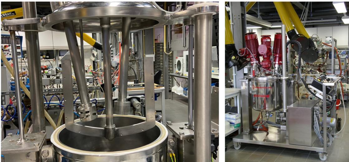
Abbildung 12: Foto eines 60 L Reaktors. links: innen, rechts: außen.
