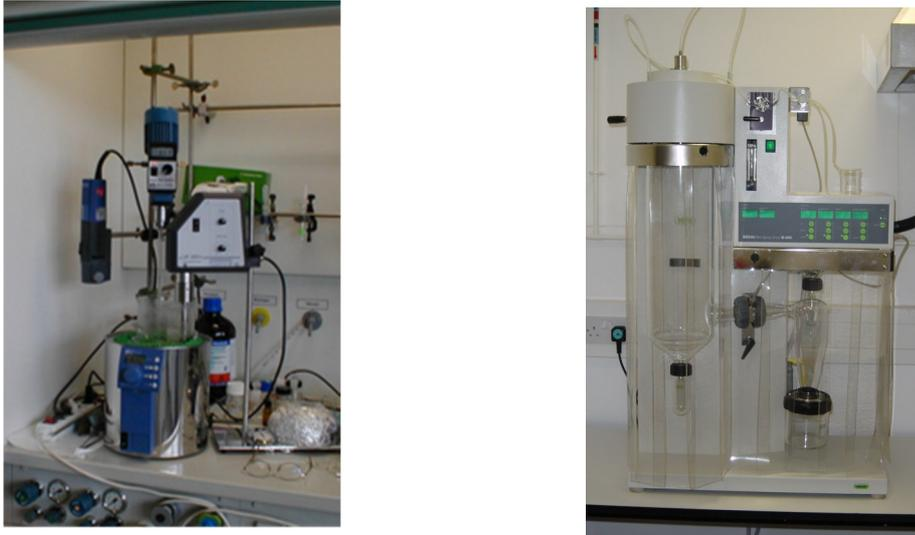
Abbildung 9: Foto von einem Laborreaktor (links) und einem Laborsprühtrockner (rechts).
