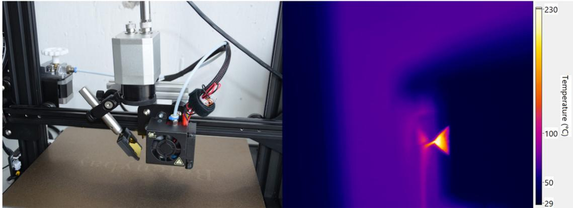
Abbildung 12: Messkonfiguration 2 zur Betrachtung der Strangablage über einen Goldspiegel (links) und ein beispielhaftes Thermogramm, in dem die Druckrichtung weg vom Spiegel verläuft (rechts)
