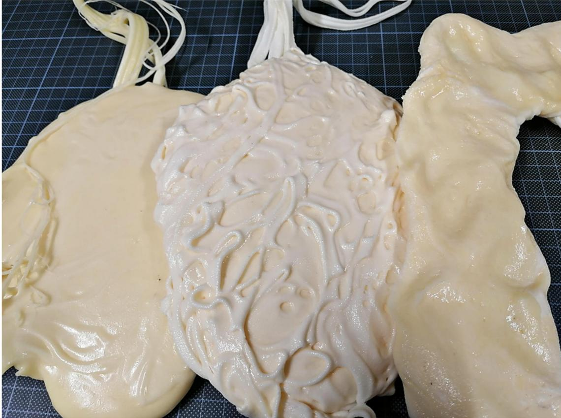
Abbildung 82: Einfluss der Zugabe von physikalischem Treibmittel auf die Verfärbung von mit expandierenden Mikrosphären beladenen TPU; links: TPU + Mikrosphären; Mitte: TPU + Mikrosphären + N<sub>2</sub>; rechts: TPU + Mikrosphären + N<sub>2</sub> – Schmelzekuchen auseinandergezogen.
