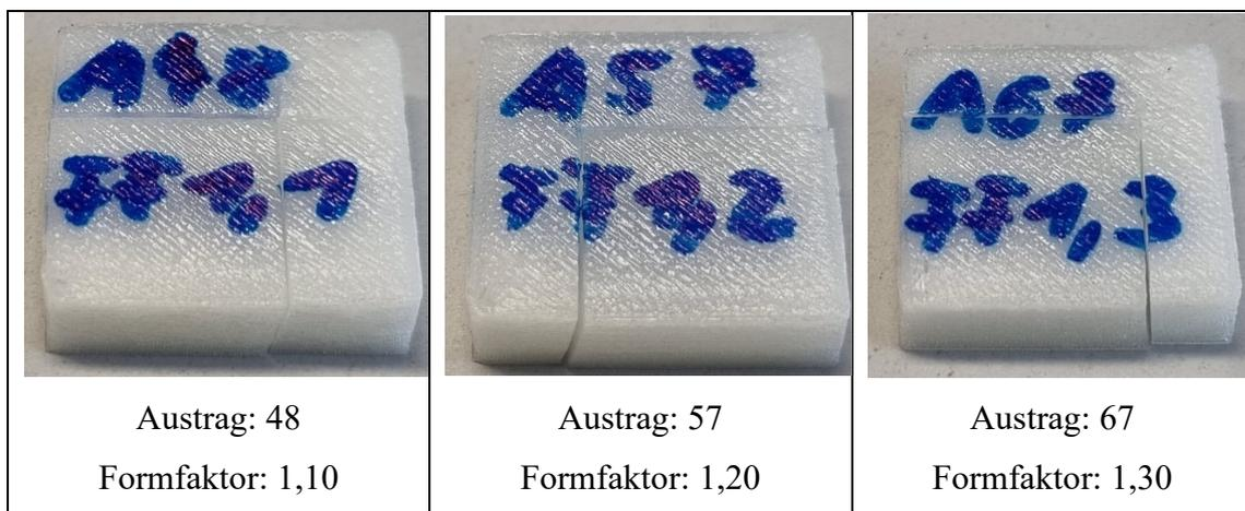
Abbildung 29: Darstellung von leicht überfüllten Probekörpern aus M1 mit unterschiedlichen Austrägen und Formfaktoren.
