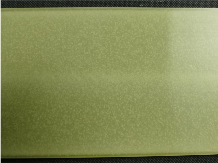
Abbildung 78: Aufnahme einer mit Mikrosphären (MS1) geschäumten TPU-Platte aus M2.
