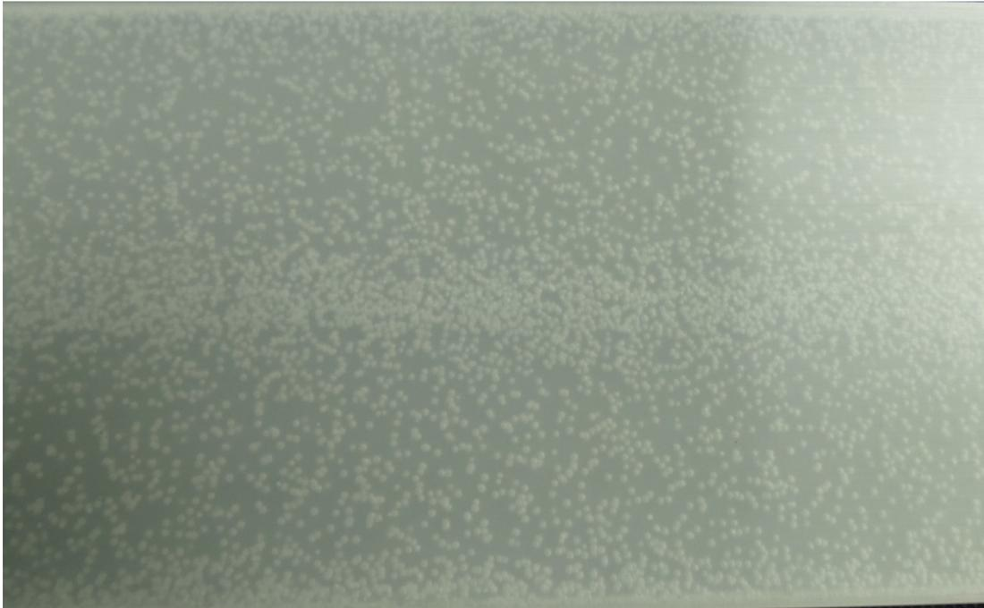
Abbildung 107: Aufnahme der sich ausbildenden Schaumstruktur beim Schäumen von TPU M2 mit dem chemischen Treibmittel EN3, Staudruck 180 bar.
