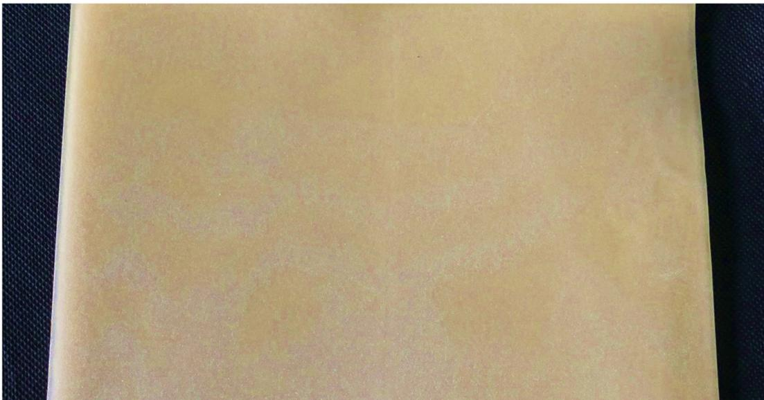
Abbildung 100: Verfärbung einer gespritzten Platte aus TPU M2 und den alternativen Mikrosphären.
