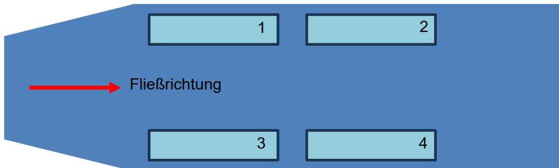
Abbildung 21: Probenentnahme und -bezeichnung der Zugstäbe.
