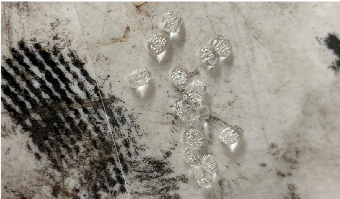
Abbildung 90: Aufschmelzen TPU-Granulat (M2) auf einer Heizplatte.
