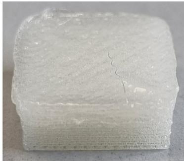
Abbildung 33: Überfüllter Quader von M1 mit Parametereinstellungen der Arburg GmbH.
