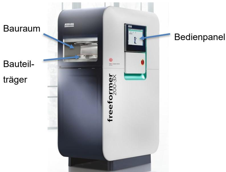
Abbildung 14: AKF-Anlage Freeformer 200-3X von Arburg. [31]
