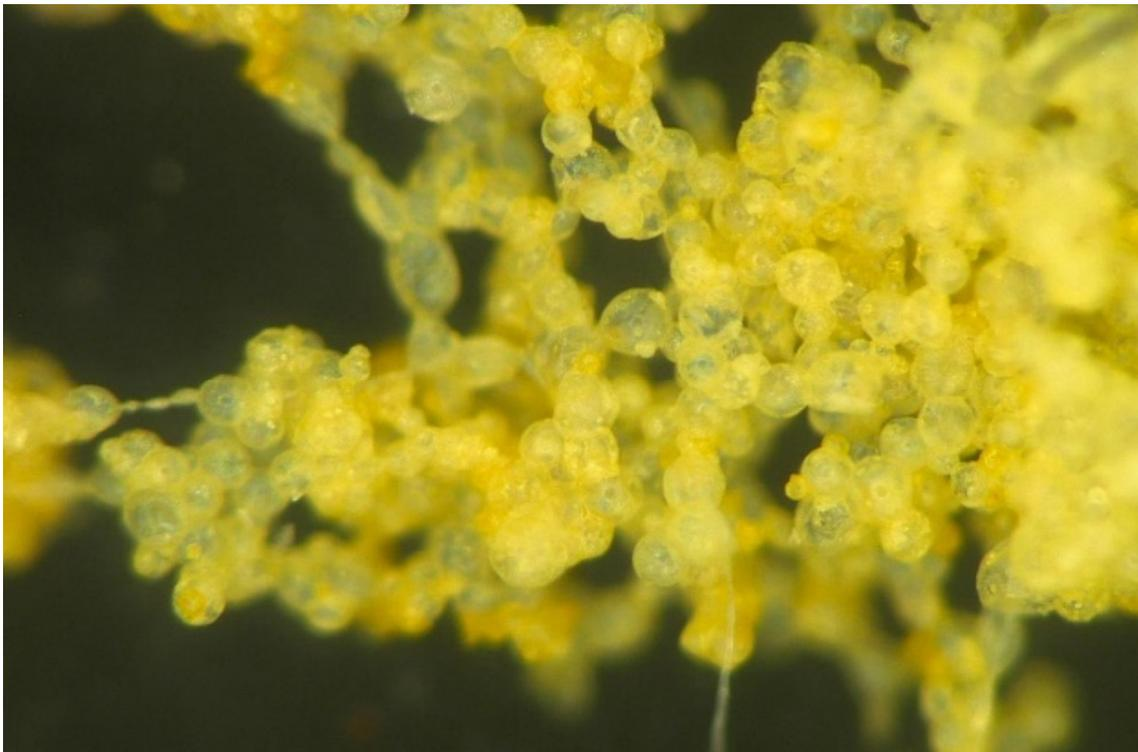
Abbildung 96: Gelbverfärbung an expandierten Mikrosphären; Produkt: MS1.
