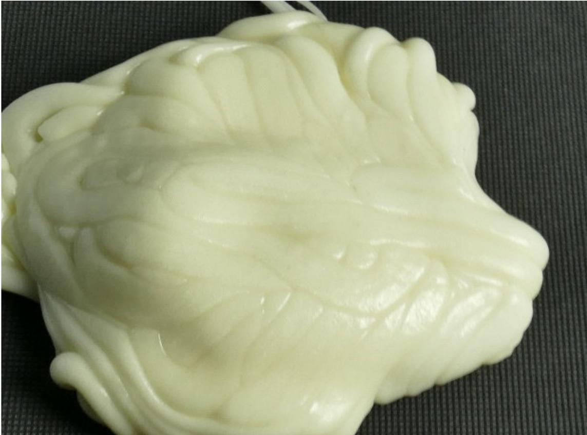
Abbildung 83: TPU-Schmelzekuchen mit Mikrosphären beladen, Verarbeitung mittels Standardschnecke.
