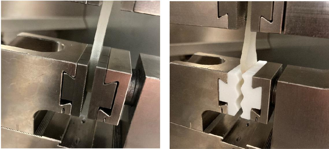
Abbildung 18: Zugprüfung links: "glatter" Einsatz rechts: Wellenstruktur.
