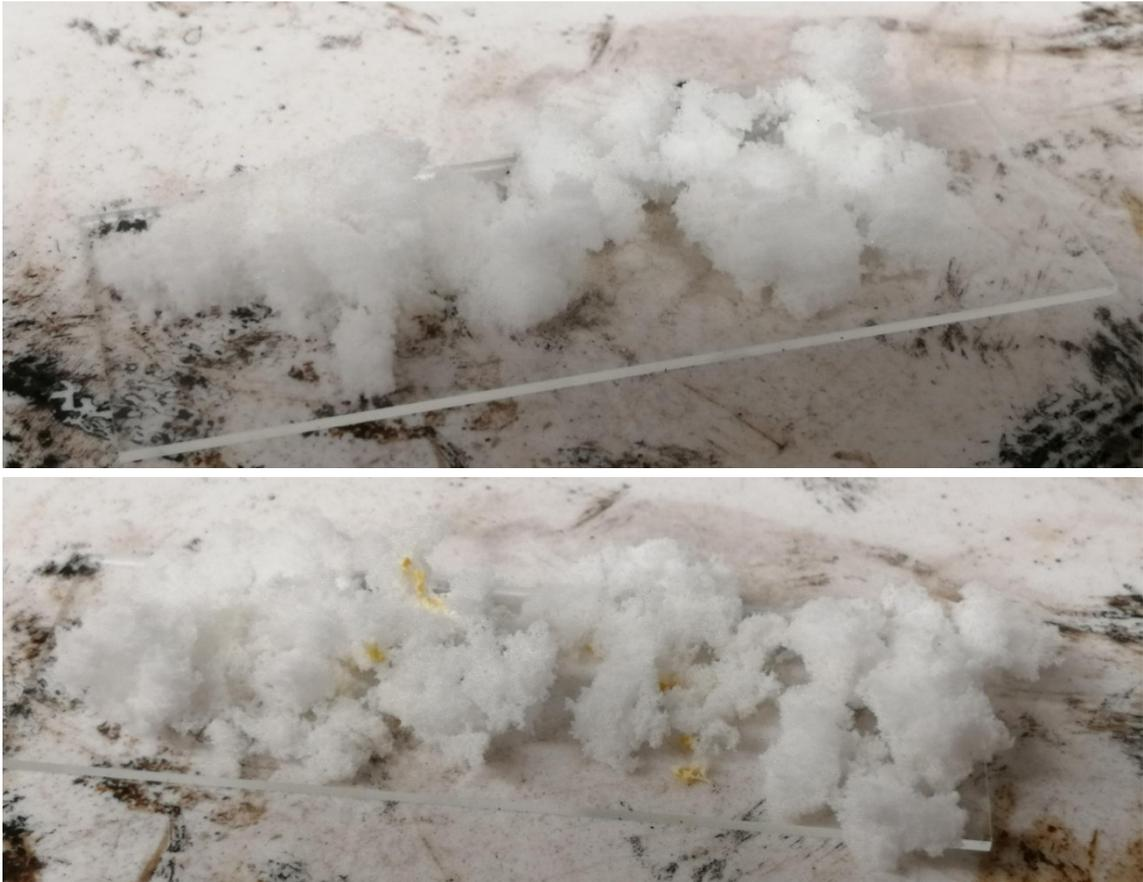
Abbildung 93: Aufschmelzen Mikrosphären (Alternative Mikrsphären) auf einer Heizplatte; oben: starke Expansion eines Granulatkorns; unten: beginnende Gelbverfärbung.
