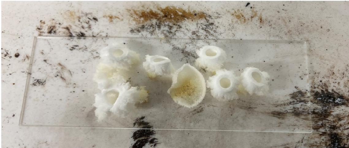
Abbildung 92: Aufschmelzen Mikrosphären (MS1) auf einer Heizplatte; beginnende Gelbverfärbung.
