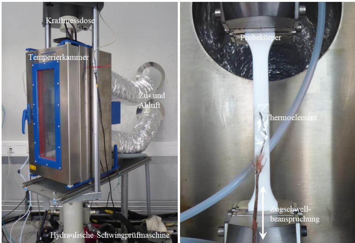
Abbildung 8.1: Gesamtsicht des Prüfaufbaus (links) und Blick in die Temperierkammer (rechts)
