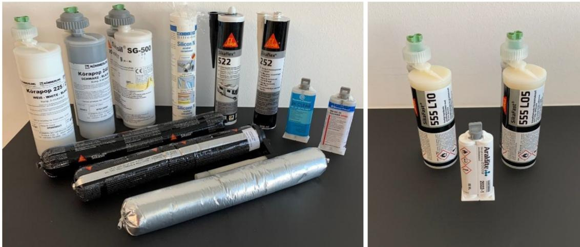
Abbildung 11: Übersicht über die seitens des pbA gespendeten und im Projekt gemessenen Polykondensationsklebstoffe (links) und Polymerisationsklebstoffe (rechts)
