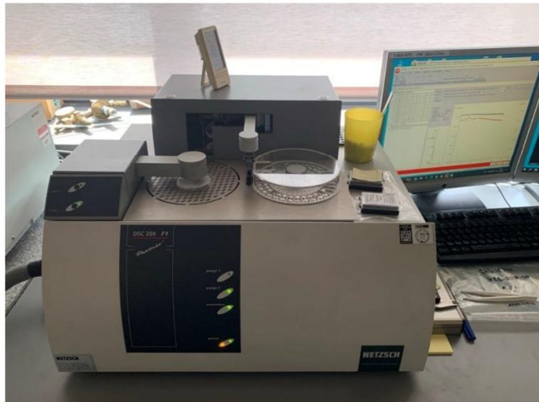
Abbildung 50: Genutzte DSC zur Messung des Aushärtegrades des Polymerisationsklebstoff Araldite 2022-01
