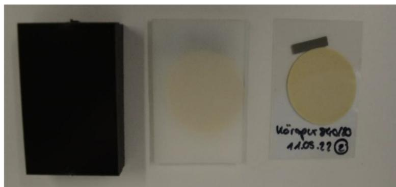
Abbildung 12: Darstellung von drei Klebeverbunden mit jeweils dem gleichen Klebstoff: PA-GF (links), PA (Mitte) und Glas (rechts)
