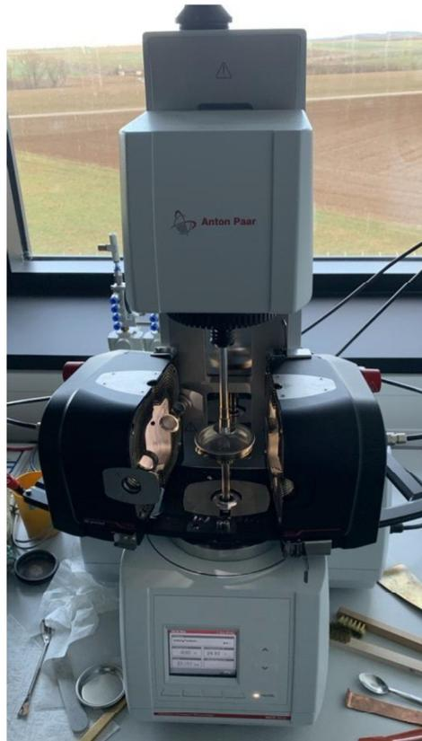
Abbildung 43: Genutztes Platte/Platte-Rheometer der Fa. Anton Paar Group AG
