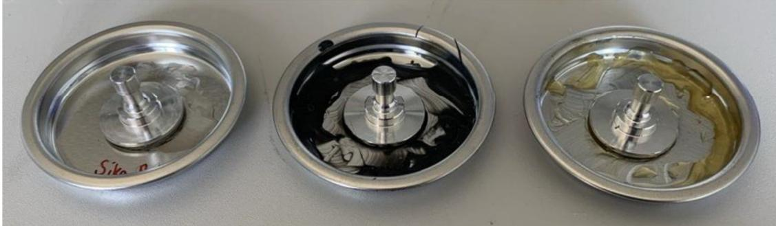
Abbildung 44: Verwendete Wechselplatten für die Messungen im Platte/Platte-Rheometer mit den Klebstoffen SikaFast 555 L05 (links), SikaForce 7570 (mitte) und Araldite 2022-01 (rechts)
