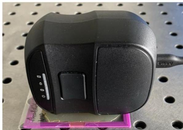
Abbildung 47: Berührende Messungen mit dem NIR-Spektrometer an einem Klebeverbund
