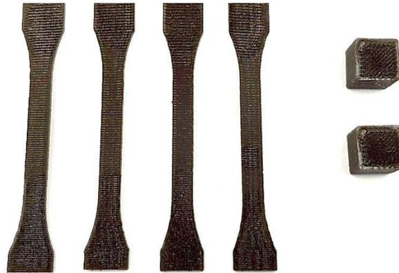
Abbildung 61: Im FLM gedruckte Zugstäbe und Würfel aus PLA+PUMag
