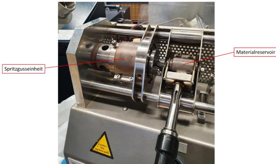
Abbildung 11: Beheizte Spritzgussvorrichtung, die zur Herstellung der Zugprobekörper des Typs 5A genutzt wurde.
