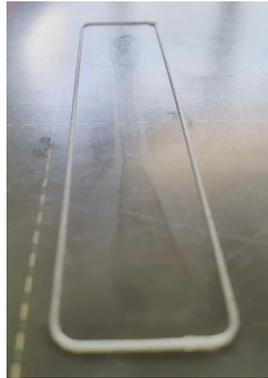
Abbildung 44: Öl auf der Bauplattform, das während des FLM-Drucks der schmierstoffkapselgefüllten PLA-Filamente ausgetreten ist
