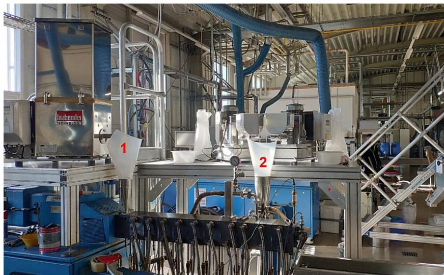
Abbildung 13: Compoundherstellung mit Doppelschneckenextruder ZKS26 MC18
