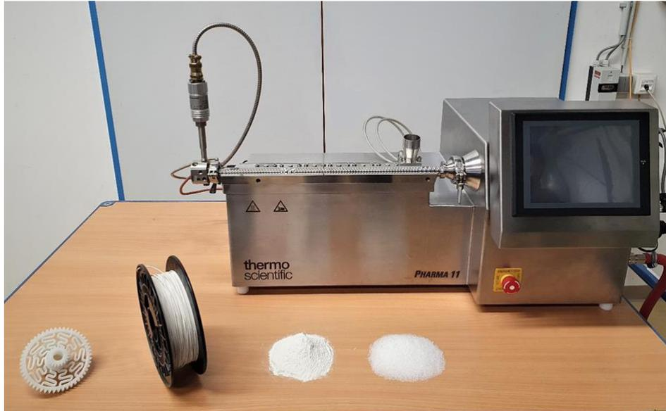
Abbildung 12: Compoundherstellung mit Doppelschneckenextruder Pharma 11
