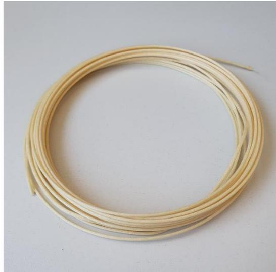
Abbildung 20: Filament eines PLA + 10wt% PULupa45 Compounds, das mithilfe des Compo-ser 450 Desktop-Extruders hergestellt wurde.
