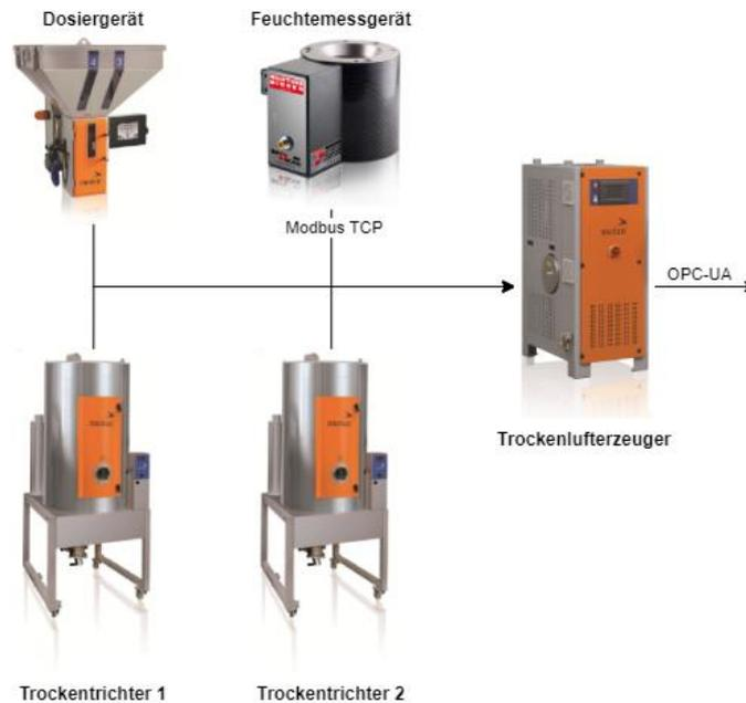
Abbildung 9: Bestandteile des Trocknungssystems und deren Vernetzung
