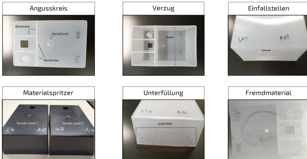
Abbildung 15: Weitere erzeugte optische Fehlerbilder am Bauteil „Verzugsschale“
