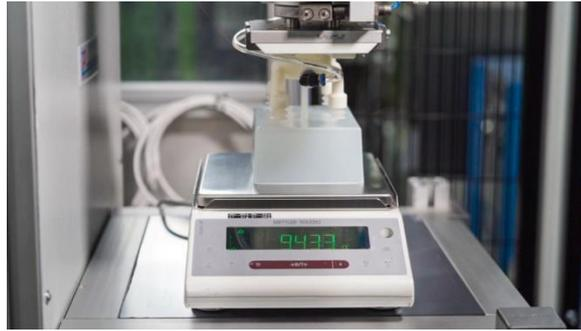
Abbildung 7: Integrierte Industriewaage des Unternehmens Mettler-Toledo zur Aufzeichnung des Gewichtwertes
