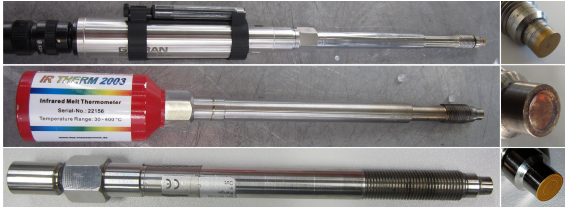
Abbildung 10: Abbildung der genutzten Sensortypen, sowie deren Sensortspitze (rechts): Masse-drucksensor (oben), Massetemperatursensor (Mitte), kapazitiver Sensor (unten)
