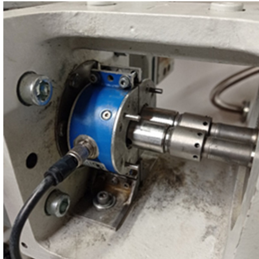
Abbildung 22: Aufgebautes Magnetostruktionsmesssystem zwischen der Antriebs- und der Verfahrenseinheit mit den beiden Extruderschnecken
