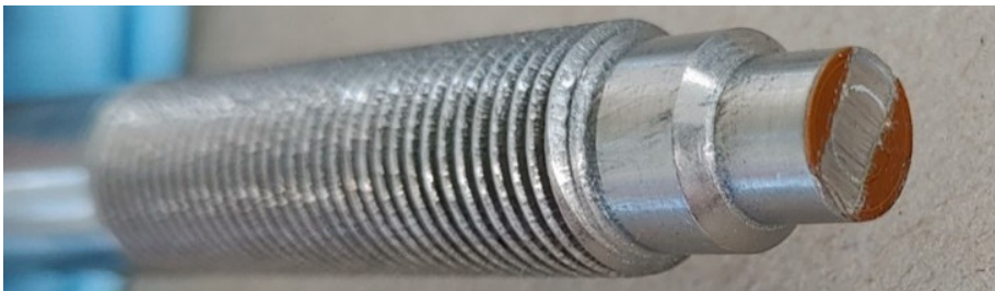
Abbildung 15: Die Abschürfungen durch den Schneckensteg an der Sensorspitze (gegenüber Abbildung 10, unten rechts) sind deutlich zu erkennen. Infolgedessen trat ein Kurzschluss auf, der die angeschlossene Messelektronik ebenfalls beschädigte.
