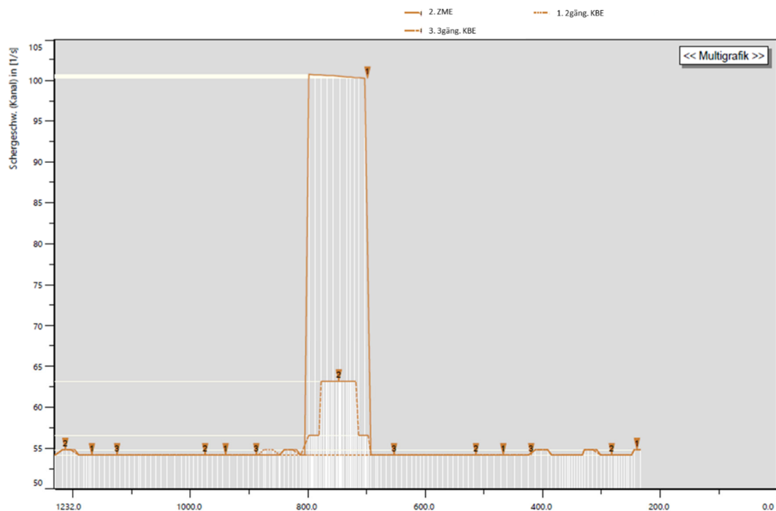
Abbildung 116: Schematische Abbildung der Schergeschwindigkeiten der drei Schneckenkonfigurationen entlang des Extruders
