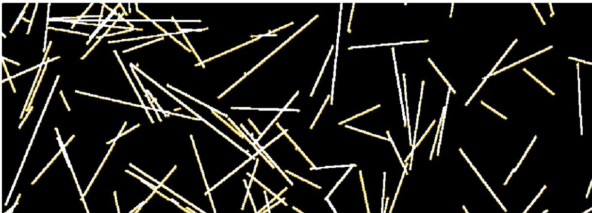
*Über den Mindestbreite-Filter auf mind. 3 Pixel vereinheitlichte Fasern (hellorange: ergänzte Pixel)*
