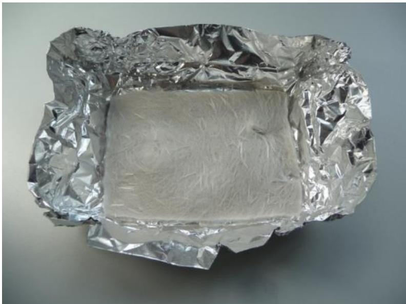
*Veraschte Probe eines langglasfaserverstärkten PP*
