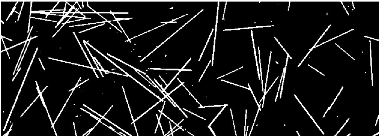
*Binarisiertes Graustufenbild mit Schwellenwert 57*
