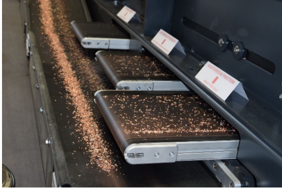
[2] Wirbelstromscheider sortiert ferromagnetische Metalle, leitende Materialien und nichtleitende Materialien
