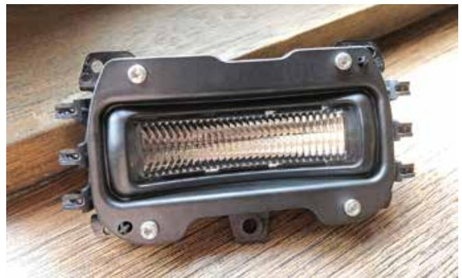
Tilman Maucher stellte mit einem Scheinwerfer mit blendfreiem Fernlicht eine spannende LSR-Anwendung aus der Automobilbeleuchtung vor.
