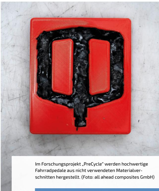
Im Forschungsprojekt „PreCycle“ werden hochwertige Fahrradpedale aus nicht verwendeten Materialverschnitten hergestellt. (Foto: all ahead composites GmbH)
